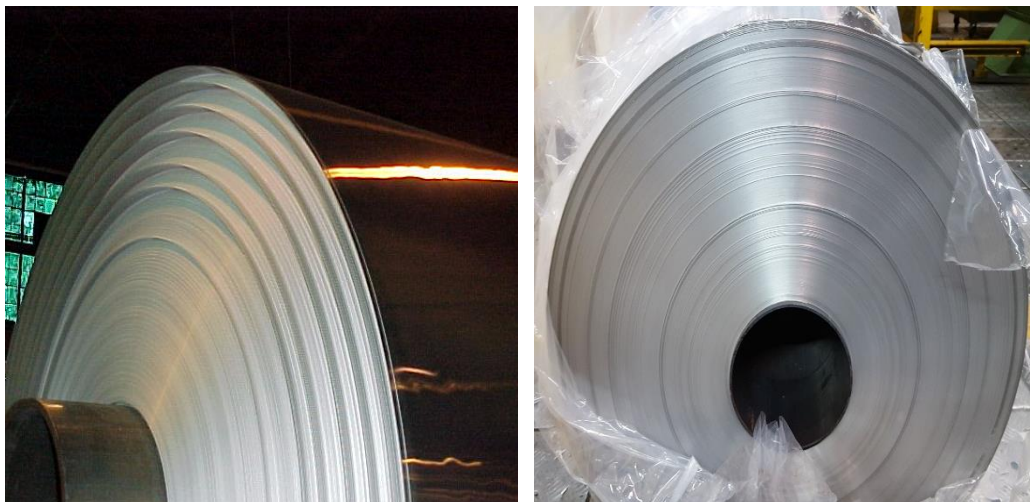
Figura 14 – Bobinas apresentando telescopagem
