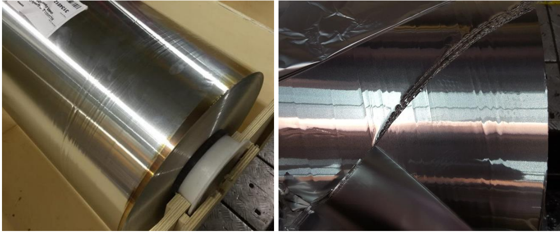
Figura 13 – Bobinas com a presença de rugas
