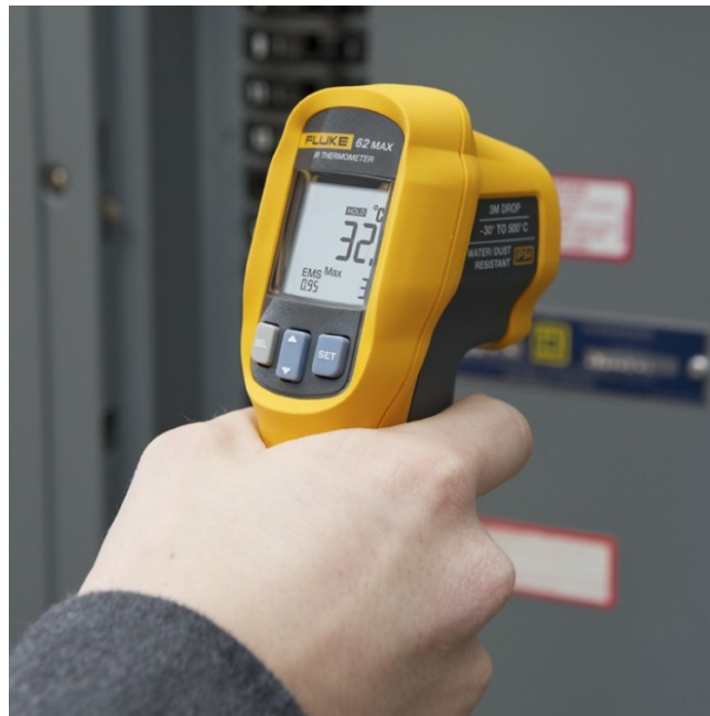
Figura 15 – Imagem ilustrativa da medição realizada por infravermelho
