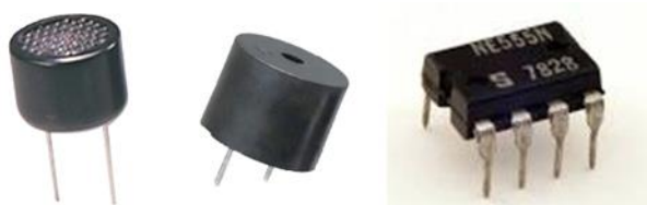
Figura 5: Transmissor e receptor de ultra-som e circuito integrado NE555.
