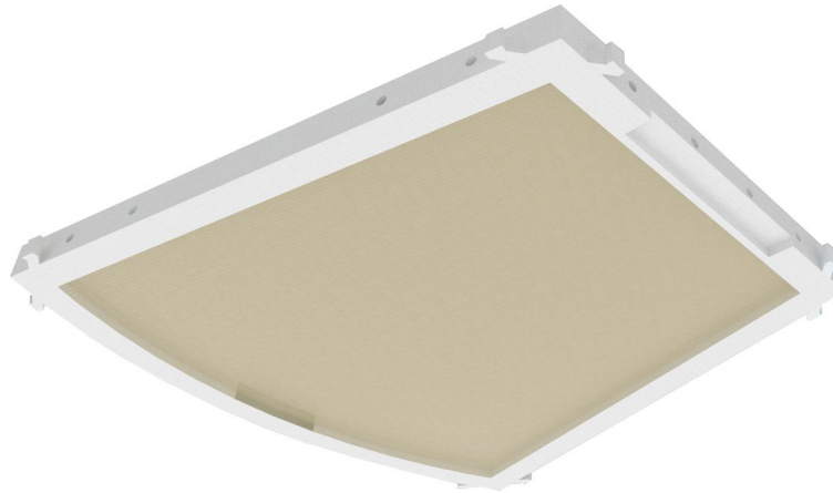
Figura 93: perspectiva da parte inferior da base com a tela de fibra aramida Kevlar.
