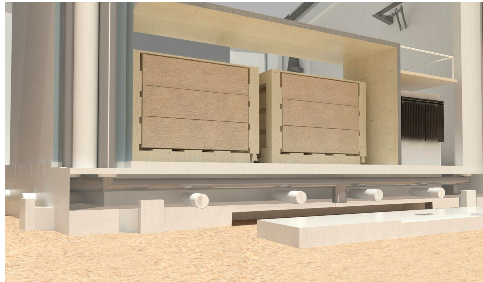
Figura 87: escoamento das águas pluviais nos pilares posteriores, com armazenamento
