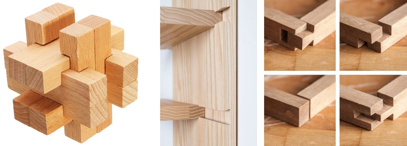
Figuras 55, 56 e 57: Quebra-cabeça tridimensional e encaixes de engenharia japonesa.
