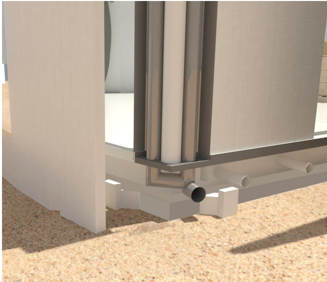
Figura 86: escoamento das águas pluviais nos pilares frontais
