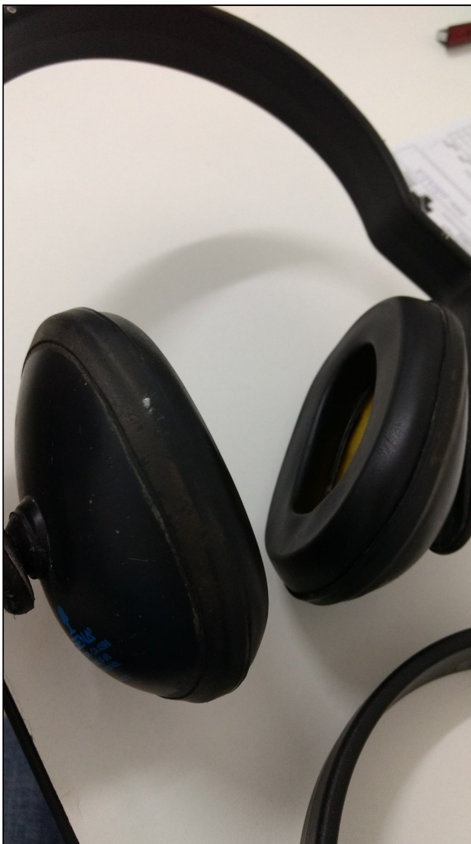
Figura 21 - Detalhe da espuma do protetor com seis meses de uso
