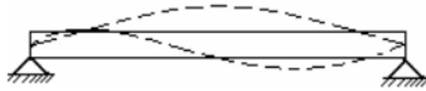
Figura 2: Modelo de viga bi apoiada para Eixos Rotativos de Dunkerley
