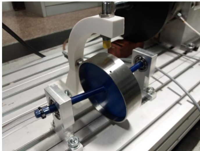
Figura 24: eixo quebrado após excitação em rampa
