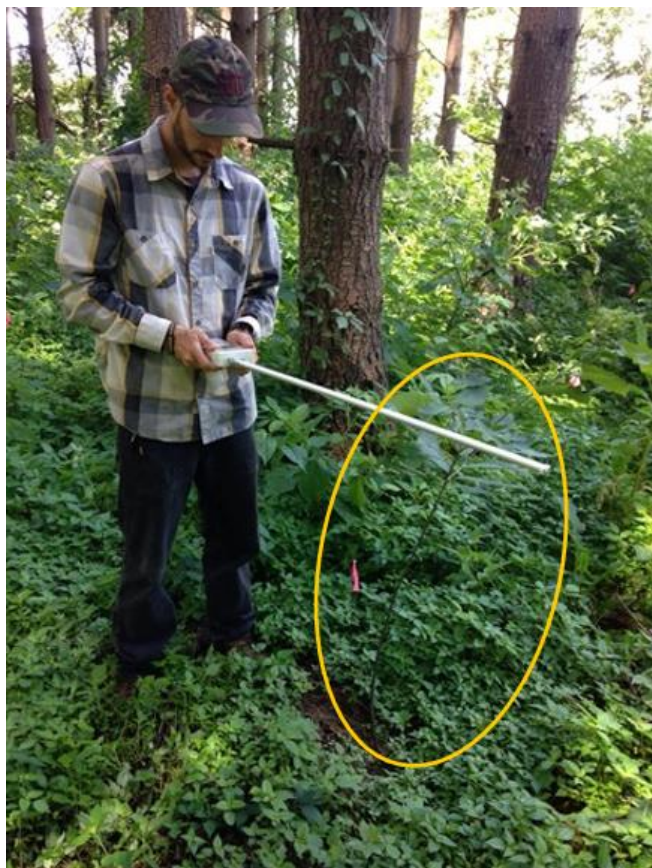
Figura 8. Medição da radiação fotossinteticamente ativa (RFA) através do uso do ceptômetro.
