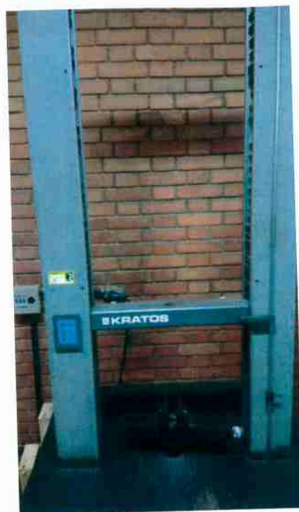
Figura 4 - Equipamento utilizado no ensaio de compressão.
