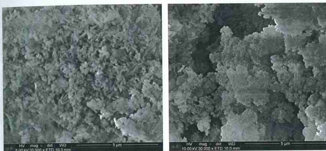
Figura 8 - Imagem de MEV, com aumento de 30.000 x, de argila sintetizada por 24 e 48 horas, respectivamente.
