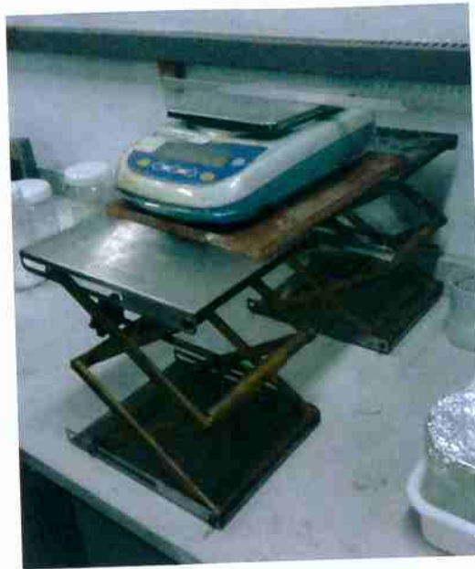
Figura 3 - Equipamento para medida do peso imerso, montado em laboratório.
