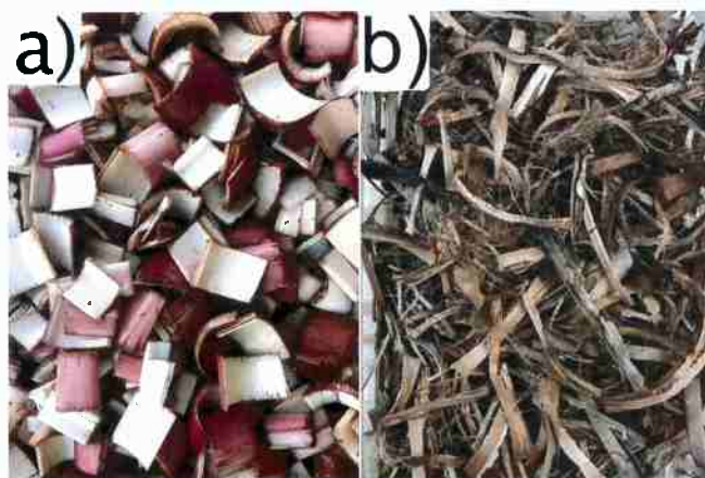
Figura 14: a) Pseudocaule de bananeira cortado em pedaços pequenos, de aproximadamente 5x5 cm. b) Pseudocaule de bananeira após secagem na estufa a 60°C, por 4 dias.
