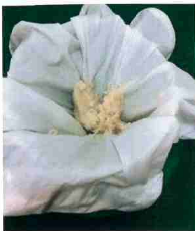
Figura 21: Polpa de celulose obtida ao final do pré-tratamento das fibras
