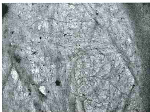
Figura 27: Micrografia da amostra NC1, na qual é possível observar a rede formada pelas fibrilas de celulose. À direita, o gráfico da distribuição de frequência dos diâmetros das fibrilas encontradas na amostra NC1.
