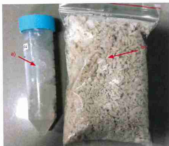
Figura 16: Amostra de nanocelulose comercial. a) Solução de nanocelulose em gel b) Nanocelulose com 10% de umidade.
