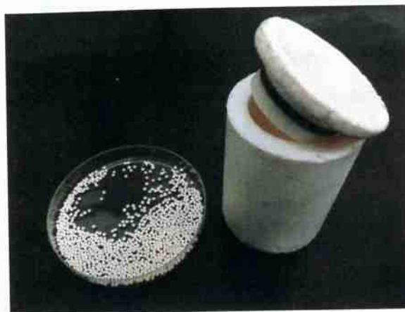
Figura 22: Recipiente de Teflon e bolas de zircônia empregadas na moagem.
