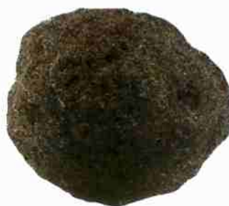
Figura 15: Pó de bananeira obtido após a moagem das fibras vegetais secas, em moinho de facas.
