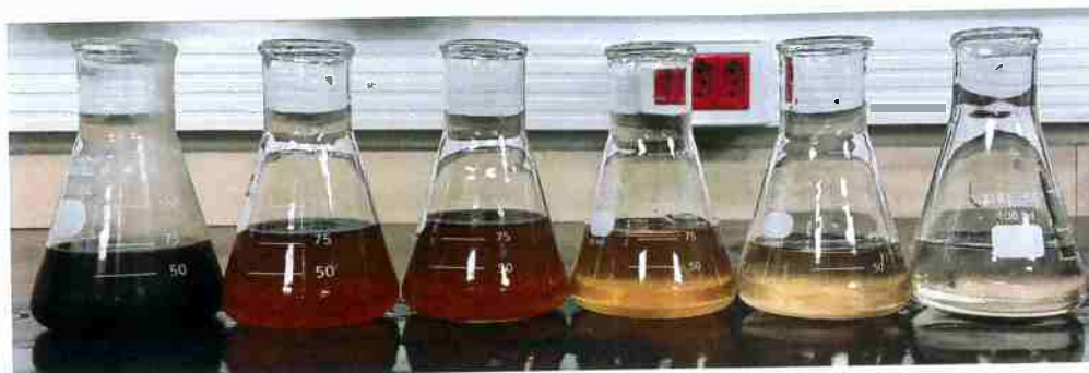
Figura 19: Mudança da coloração da água residual do processo de filtração das fibras.
