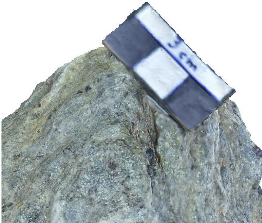
Figura 45 – Foto da amostra Granada-quartzo-biotita xisto. Delimitada em verde a região de foco da captura que apresenta maior definição de detalhes e em vermelho região fora do foco da captura, apresentando baixa definição.
