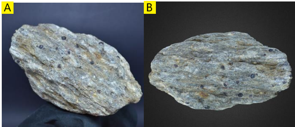
Figura 29 – A) Foto do Granada-quartzo-biotita xisto; B) resultado da digitalização 3D, publicado na plataforma Sketchfab ( https://skfb.ly/ozZQ7 ).
