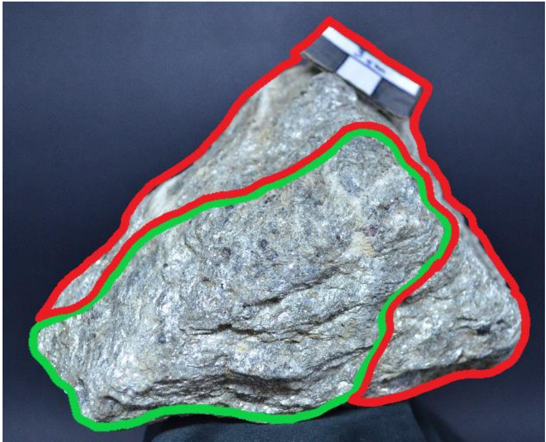
Figura 45 – Foto da amostra Granada-quartzo-biotita xisto. Delimitada em verde a região de foco da captura que apresenta maior definição de detalhes e em vermelho região fora do foco da captura, apresentando baixa definição.
