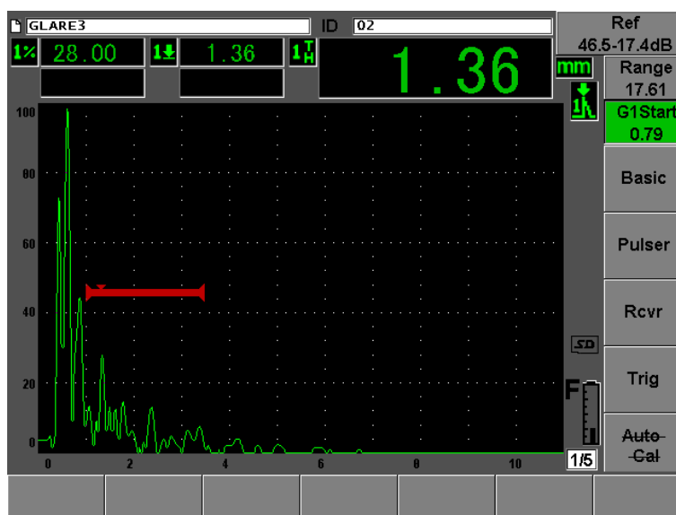
Figura 34 - Defeito encontrado a 0.8 mm da superfície do GLARE.
