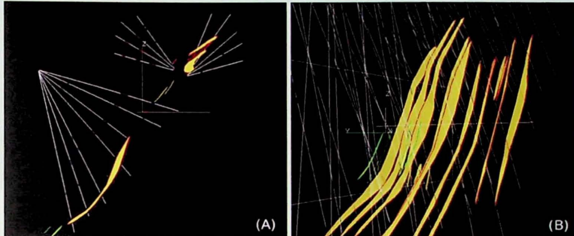
Figura 5: Modelagem geológica do corpo mineralizado a partir da interpretação de seções verticais. Em (A) é possível observar a interpretação de uma seção particular, e em (B) todo o depósito está interpretado, pronto para formar o sólido do minério.
