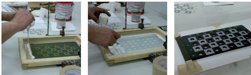
Fig. 215 a 217. Impressão em serigrafia
