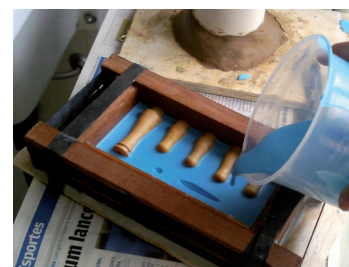
Fig. 208. Conformação do molde Fonte: imagem da autora
