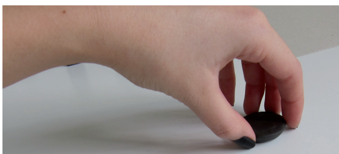
Fig. 148. Verificação da pega. Por ser muito baixo, é um objeto difícil de “pinçar” com os dedos, além de forçar o punho a uma posição desconfortável.
