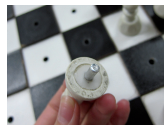
Fig. 106. Detalhe do sistema de encaixe peça/tabuleiro
