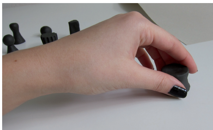
Fig. 151. Verificação da pega. Posição confortável para o punho e uso de quatro dedos para pinçar o objeto.
