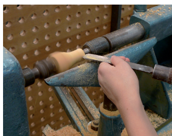
Fig. 206. Peça sendo torneada Fonte: imagem da autora
