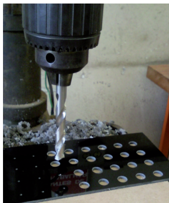
Fig. 212. Furação do acrílico Fonte: imagem da autora
