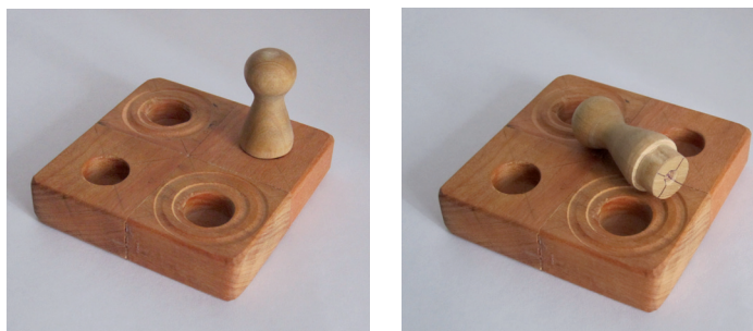
Fig. 160 e 161. Modelo funcional do sistema de encaixe macho e fêmea. Fonte: foto da autora
