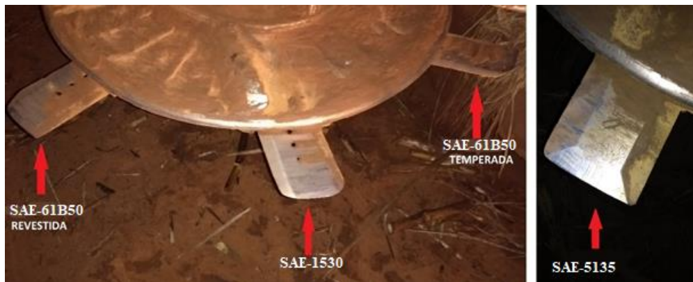
Figura 28 - Aspecto visual das peças após aproximadamente 7 horas de trabalho.
