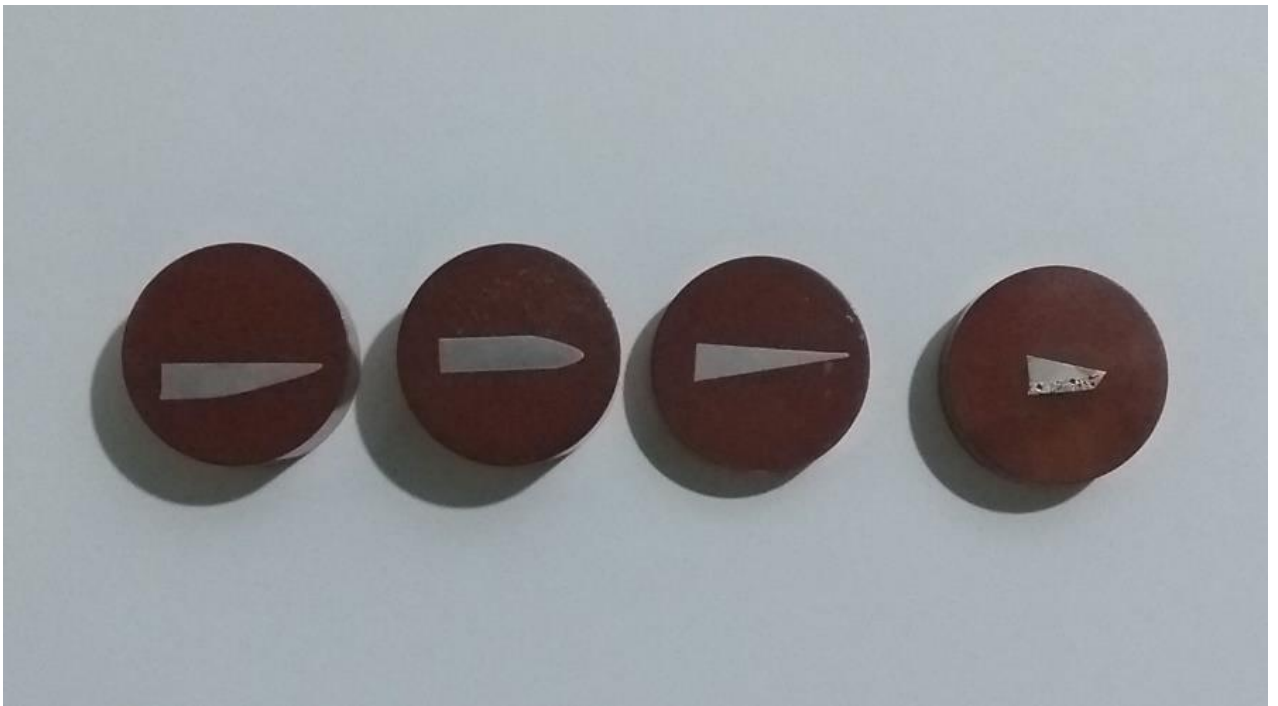
Figura 9 - Amostras preparadas e embutidas em baquelite.
