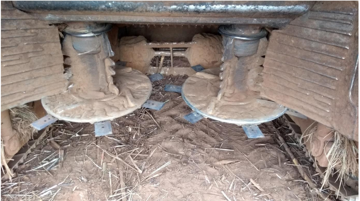
Figura 14 - Amostras fixadas no disco do cortador de base.
