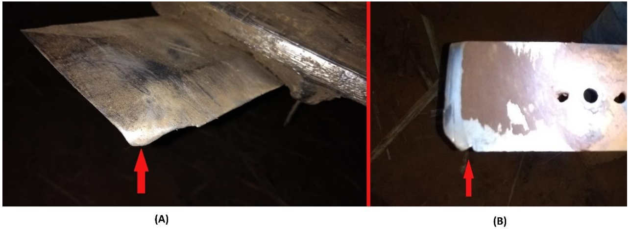
Figura 30 - Peça tida como SAE-5135 com aproximadamente 21 horas de trabalho, em destaque ponta entortada (A). Mesma peça 3,5 horas depois, com destaque a correção devido a abrasão (B).
