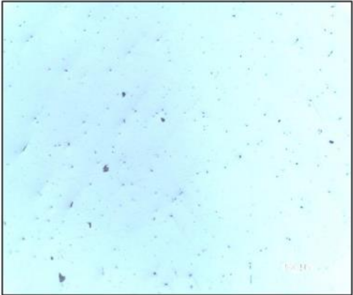
Figura 21 - Análise de inclusões da amostra tida como SAE-61B50 revestida.
