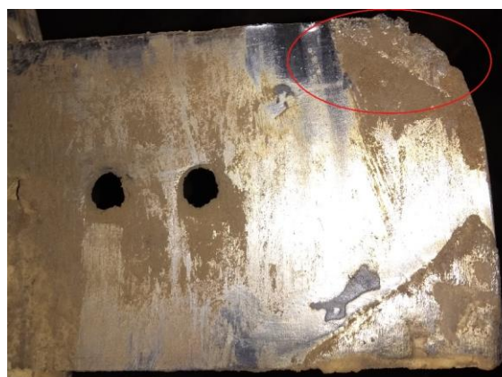
Figura 29 - Peça tida como SAE-61B50 revestida, com aproximadamente 21 horas de trabalho, indicado o lascamento do revestimento arrastando o metal base (A). Revestimento a base de WC/Co, com aumento de 10x visto no microscópio óptico, com trincas indicadas (B).
