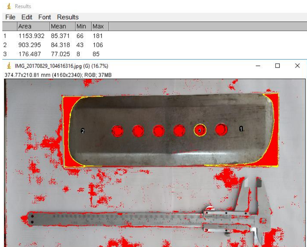
Figura 17 - Cálculo das áreas desgastadas, fazendo uso do software ImageJ .
