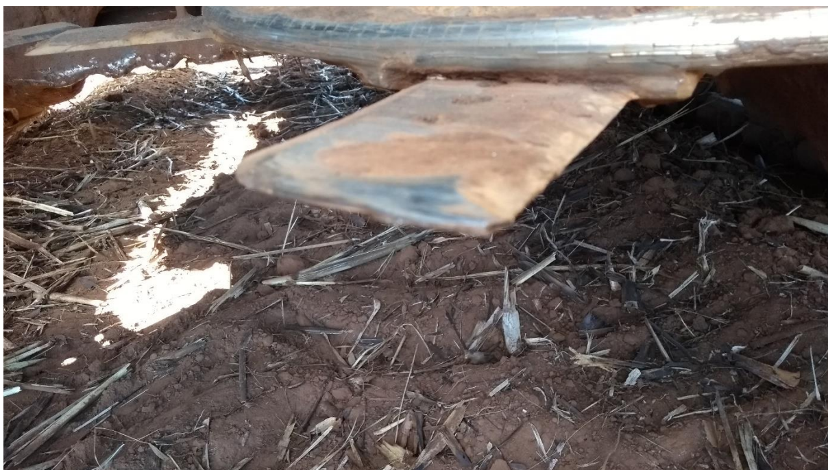
Figura 2 - Aumento na espessura do fio de corte na faca de corte basal.
