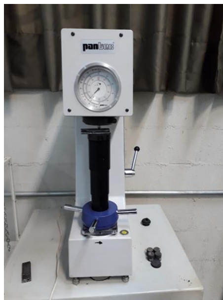
Figura 8 - Durômetro Analógico pertencente à Fatec de Sertãozinho.
