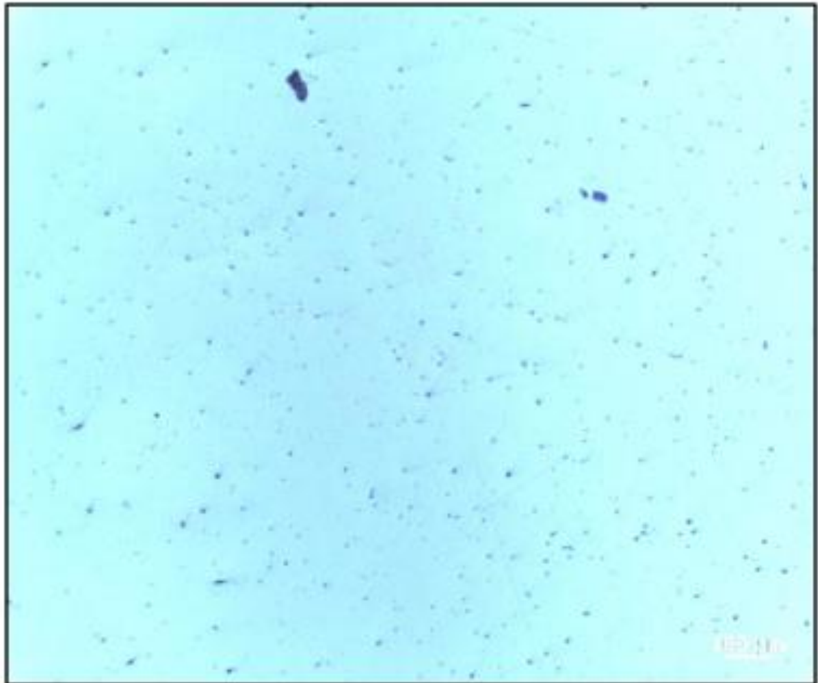
Figura 22 - Análise de inclusões da amostra tida como SAE-61B50 tratada termicamente.
