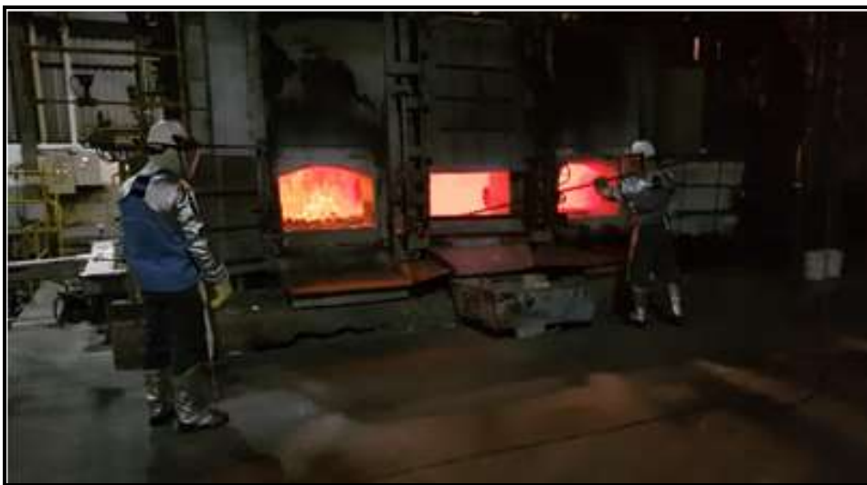
FIGURA 10 – Operadores realizando a agitação no forno secundário 02.
