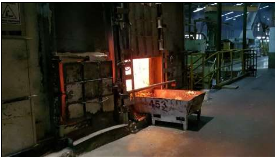
FIGURA 4 – Abertura da porta lateral, para o processo de Fluxagem.
