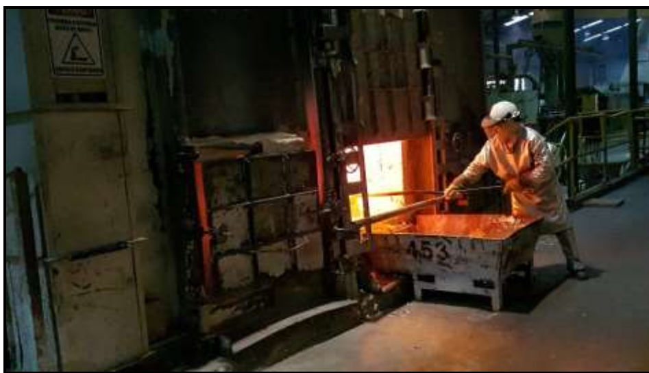
FIGURA 5 – Operador na entrada do forno, utilizando os EPI's.
