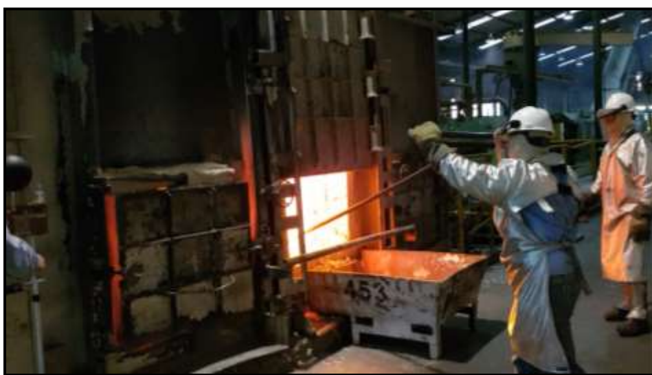
FIGURA 7 – Operador agitando as pastilhas de fluxo até derreter em toda carga.
