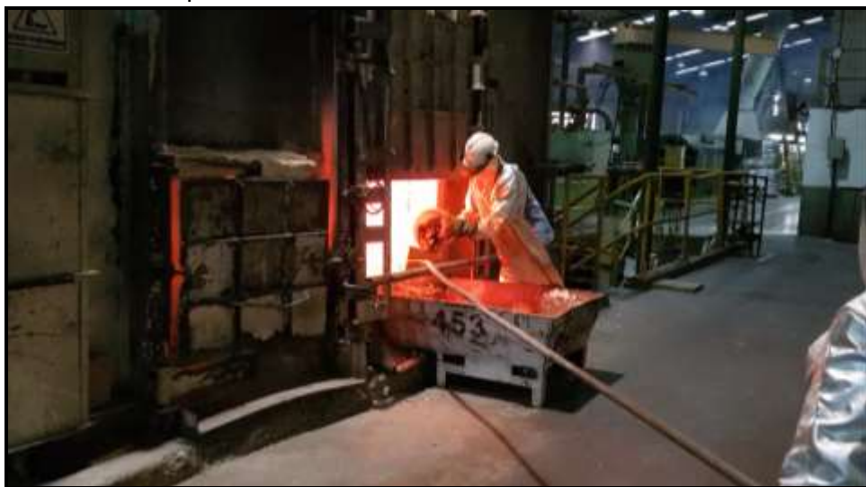
FIGURA 6 – Operador adicionando Pastilha de Alfa Fluxo no forno secundário 01.
