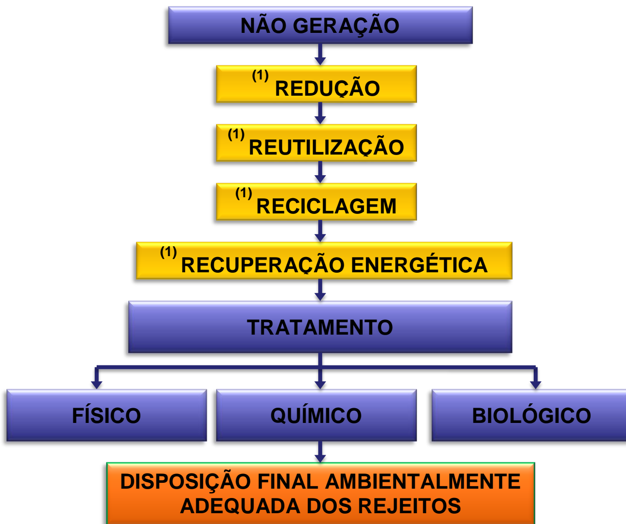
Figura 4 - Fluxo de gerenciamento do resíduo sólido (Fonte: Adaptado da Política Nacional de Resíduos Sólidos, Lei N°12.305 de 02 de Agosto de 2012)
