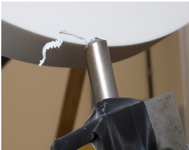
Figura 1 – Ferramenta de Ponta Única Passando no Rebolo.
