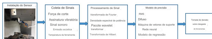
Figura 10 – Diagrama Esquemático do Sistema de Monitoramento da condição da ferramenta baseado no processamento de sinais.
