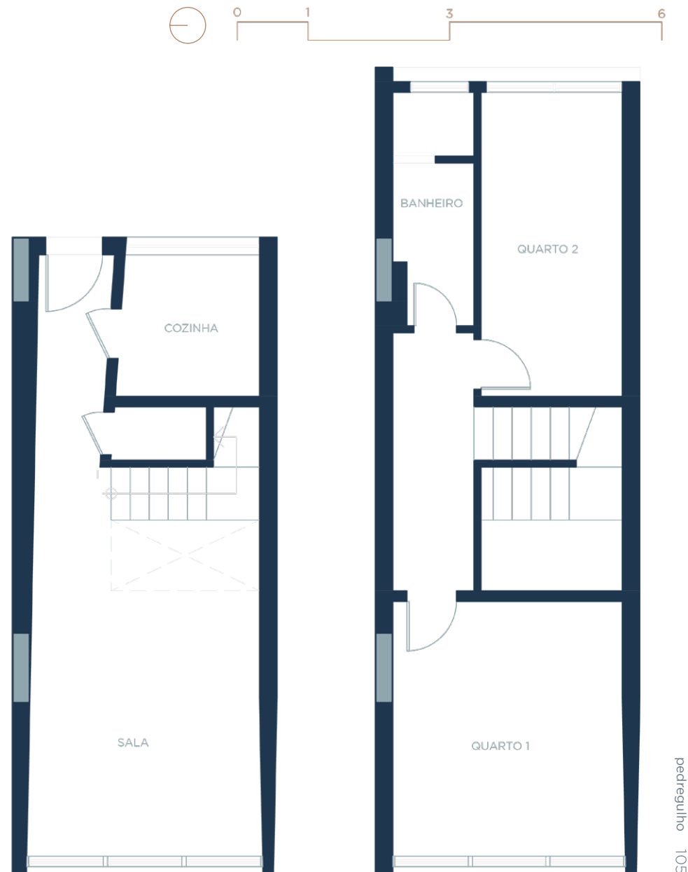
Tipologia Duplex do Bloco A - Planta | 1:75
