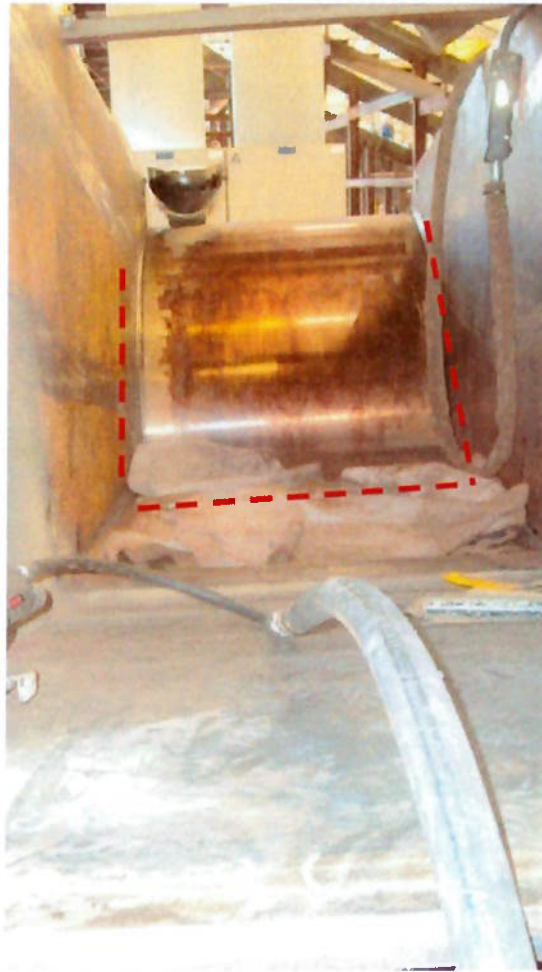
Figura 13 – Soldagem interna do equipamento, aplicação da solda no local pontilhado ambiente pré-aquecido em forno Fonte: Lima, 2010
