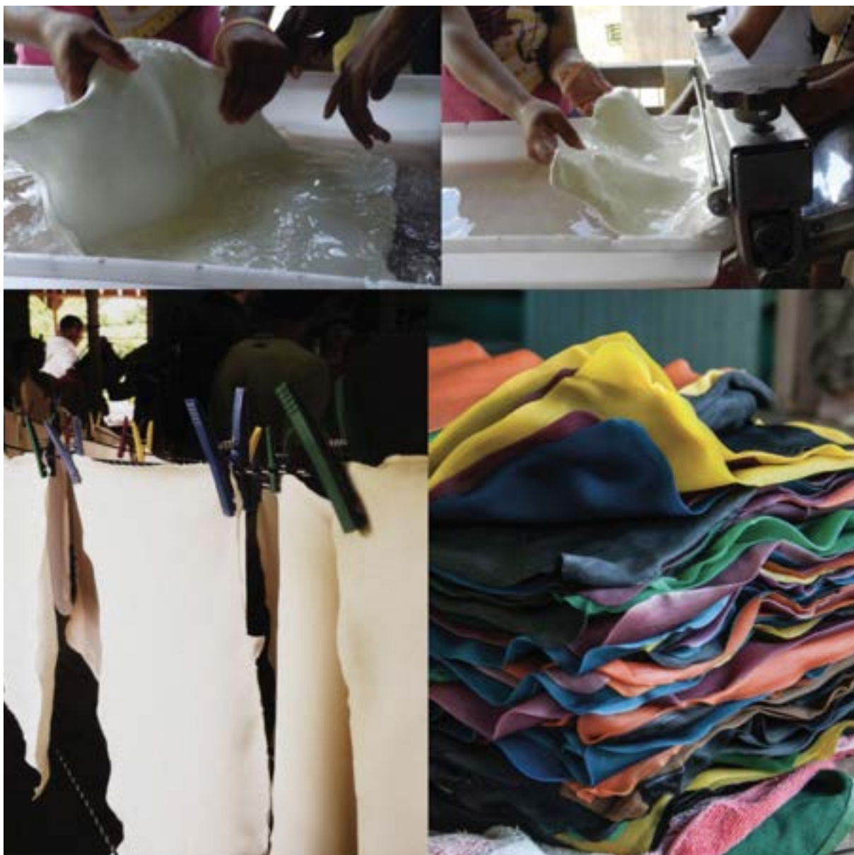
Figuras 23 a 26: Processo de secagem das mantas de látex. Fonte: https://wwfbrnew.asssets.panda.org/downloads/guia_borracha_fdl_fsa.pdf
