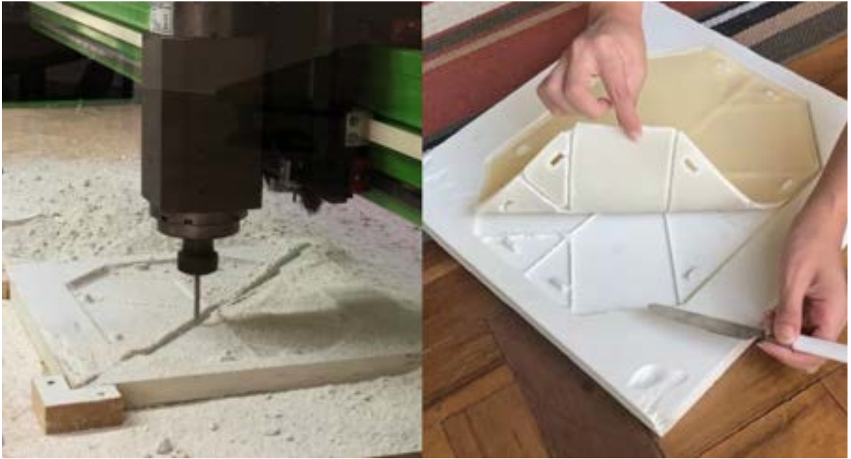
Figuras 90 e 91 Molde de gesso sendo usinado na CNC e modelo sendo desinformado do molde de gesso. Crédito: A autora.
