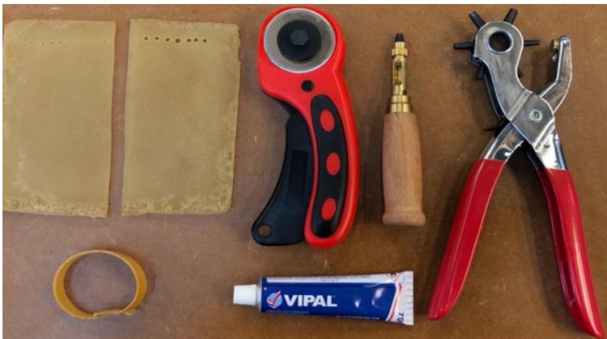
Figura 112: Ferramentas utilizadas para o corte e união de peças. Da direita para a esquerda: Furador de tecido, furador de couro, cola de borracha e estilete rotativo. Crédito: A autora.
