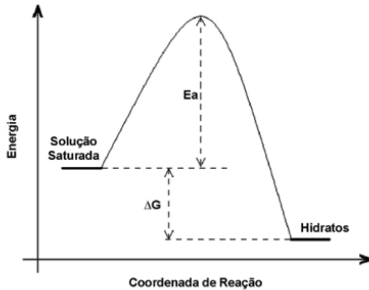
Figura 1: Diagrama de energia para a reação de hidratação do CAC
