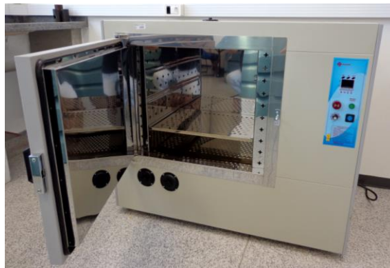
Figura 14: Forno com atmosfera controlada utilizado para os condicionamentos térmicos (Heat treatment: HT) das amostras.
