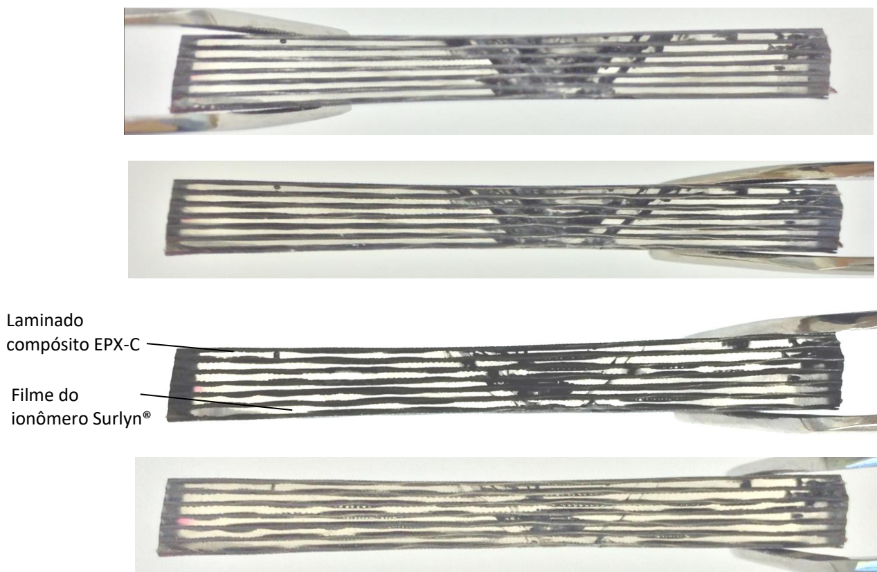
Figura 24: Fotografia da evolução do potencial de regeneração do CDP5 (2-76-2) após impacto balístico a baixas temperaturas (1ª imagem superior), após HT1 (2ª imagem superior), Após HT2 (3ª imagem) e após HT3 (imagem da base inferior);
