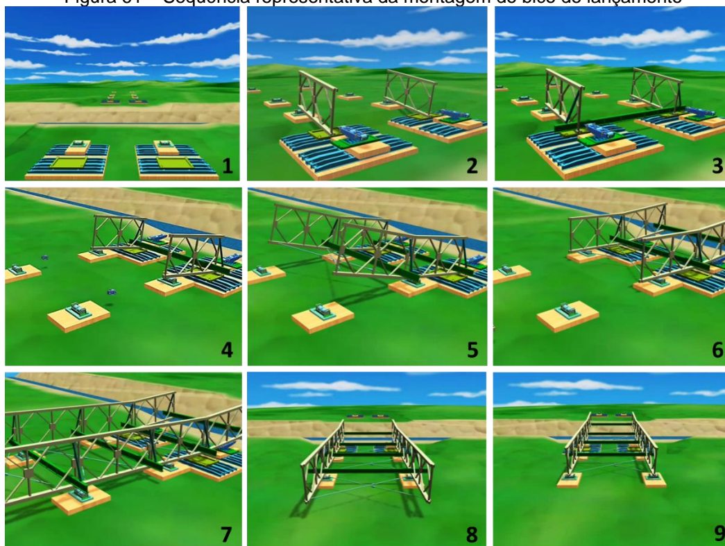
Figura 61 – Sequência representativa da montagem do bico de lançamento
