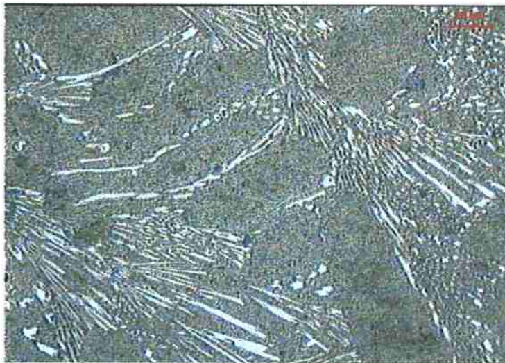
Figura 5.16: Micrografia da liga C1 em MO, com ataque metalográfico Marble.
