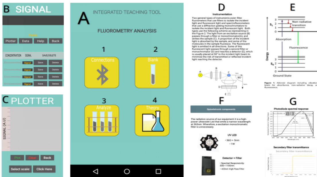
Figura 4: Tela inicial do aplicativo, onde todas as opções disponíveis podem ser visualizadas (A). A opção “Connections” destina-se ao pareamento do smartphone com o módulo BLUETOOTH do fluorímetro (A1). Uma vez conectado, o aplicativo permite realizar as funções “Blank” (A2) e “Analyze” (A3). O display da janela “Analyze” (B) apresenta a leitura atual de fluorescência proveniente dos sensores conectados ao microcontrolador Teensy 3.1 via conversor analógico digital; logo abaixo um sub-menu de ferramentas permite que os dados salvos durante a análise sejam plotados (C) e posteriormente exportados via Internet. Ao clicar no botão “Theory” um guia de estudo rápido sobre a técnica a ser estudada é disponibilizado (D e E), assim como, informações técnicas referentes a instrumentação analítica do instrumento químico (F e G).
