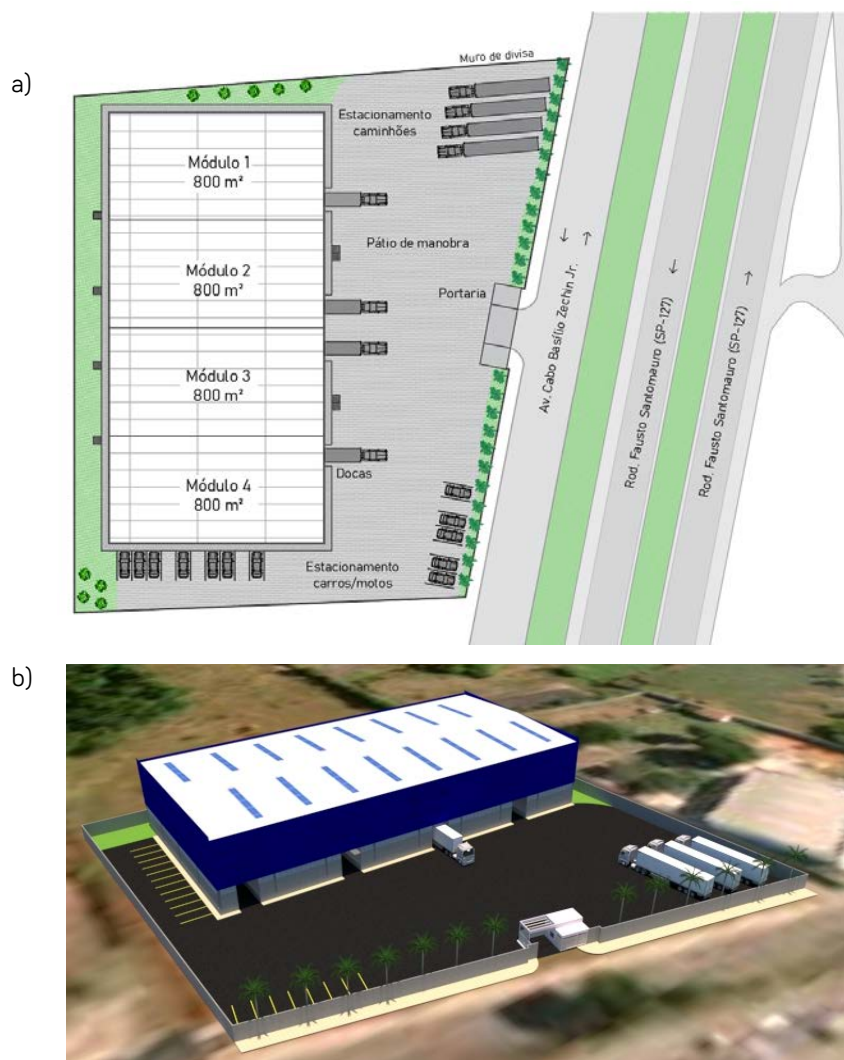
Figura 2.2: Estudo preliminar do layout da planta do centro logístico (a) e representação em perspectiva (b). Fonte: Elaborado pelo Autor
