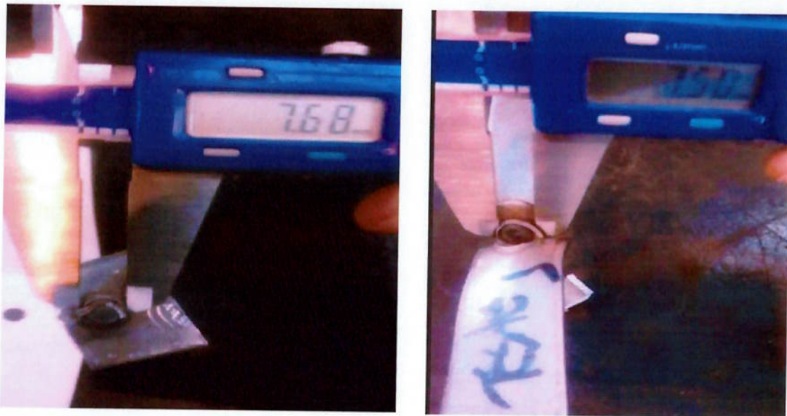
Figura 5.1: Exemplo do dimensionamento do ponto de solda, utilizando um paquímetro digital.
