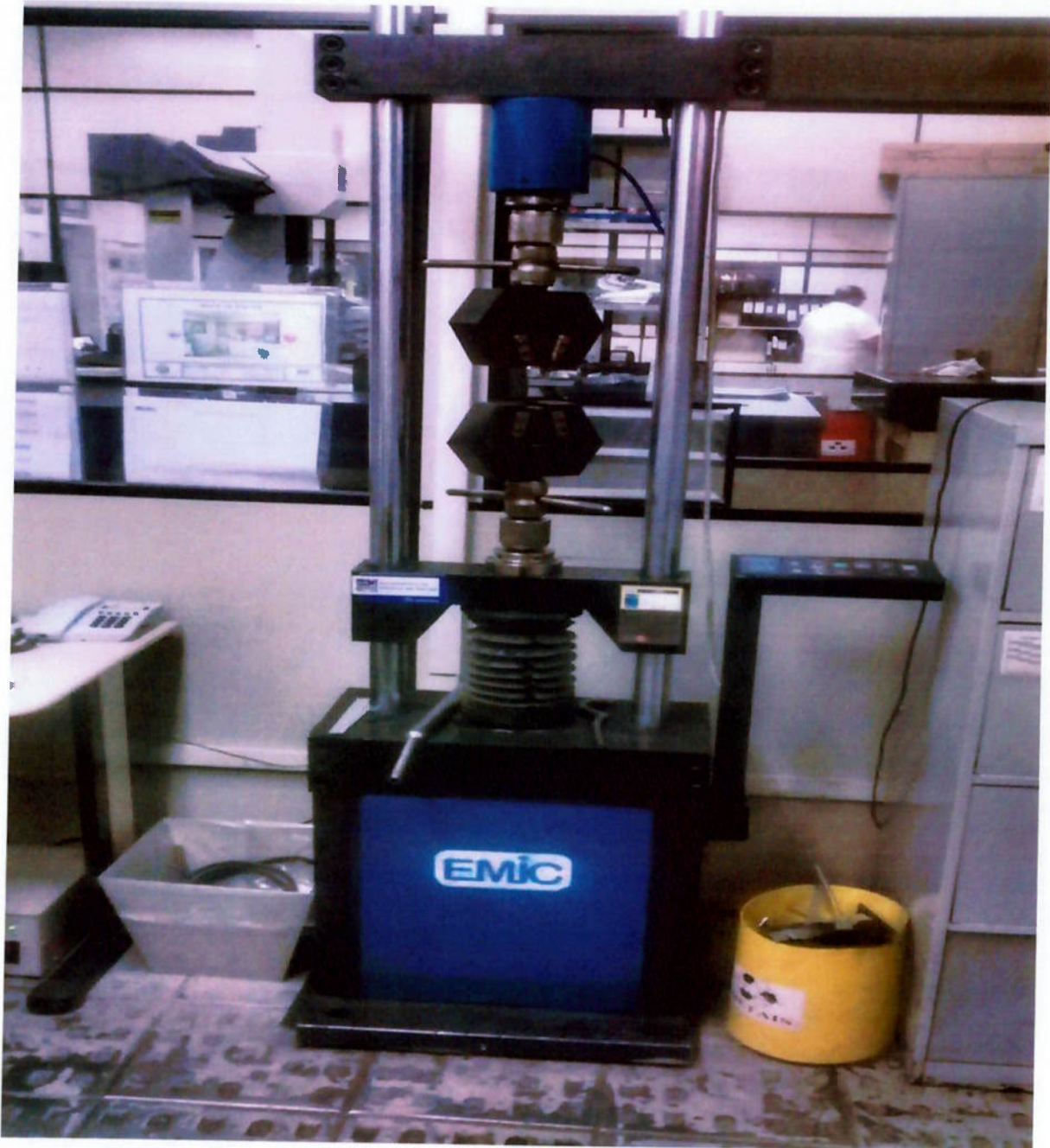
Figura 4.12: Equipamento utilizado nos ensaios de tração.
