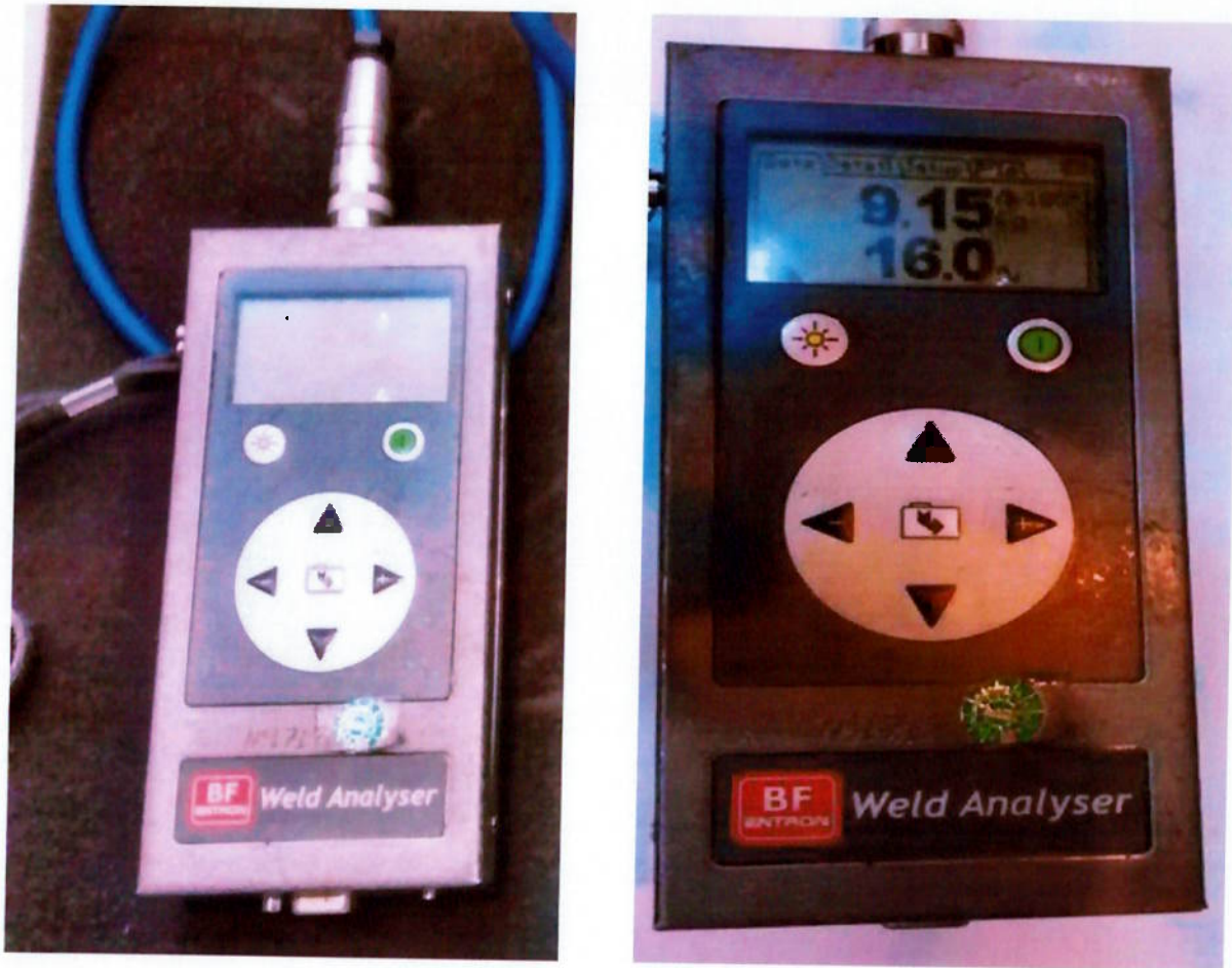
Figura 4.10: Equipamento utilizado nos experimentos para a calibração e monitoramento da tensão, corrente elétrica e o tempo de soldagem.
