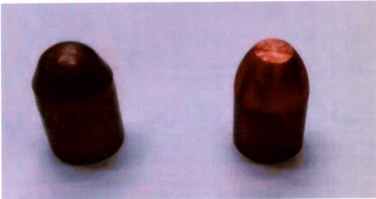
Figura 4.2: Eletrodos utilizados nos experimentos: eletrodo face esférica e eletrodo face plana , respectivamente.
