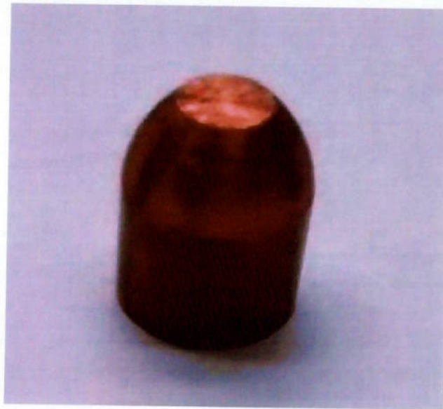
Figura 5.2: Eletrodo de face plana com diâmetro de contato de 08 mm utilizado nos ensaios com 500kgf e 1000 Kgf.
