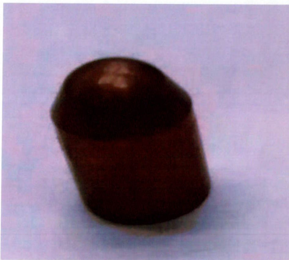
Figura 5.6: Eletrodo de face esférica com diâmetro de contato de 4,6 mm utilizado nos ensaios com 500kgf.
