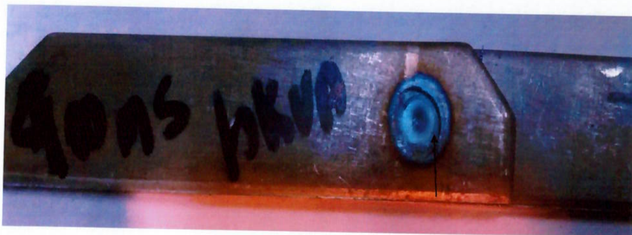
Figura 5.5: Expulsão de material líquido, devido a alta densidade de corrente causada por uma força insuficiente entre os eletrodos.
