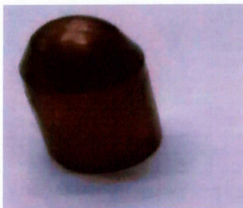
Figura 4.3: Geometria e dimensões do eletrodo de face esférica de contato.
