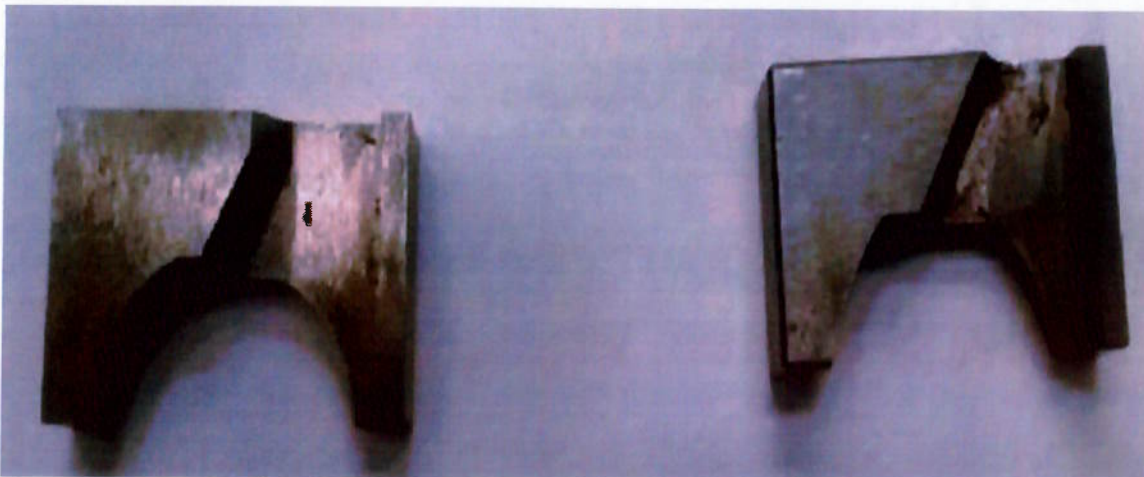
Figura 4.9: Laminas utilizadas no frezador para ajustar os eletrodos de face de contato esférico (4,6 mm) e eletrodos de face de contato plano (08 mm), respectivamente.
