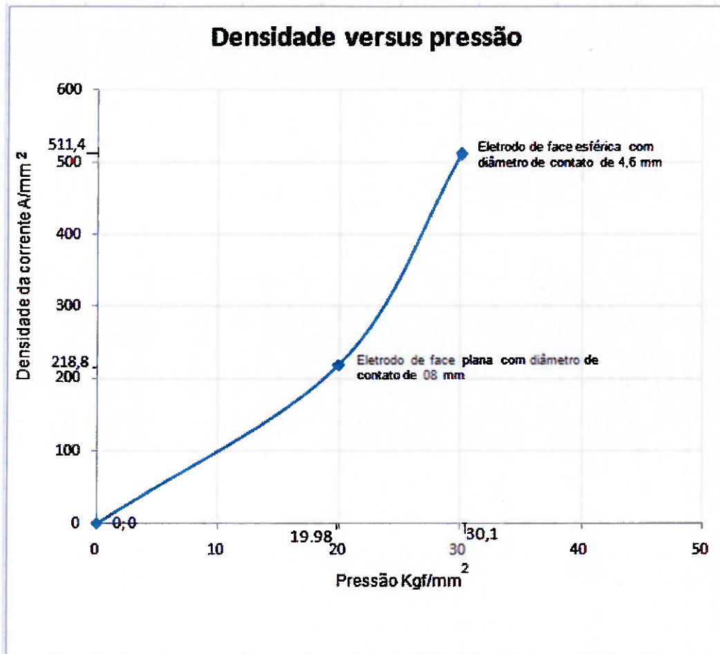
Figura 5.19: Gráfico da Densidade de corrente (A/mm 2 ) versus pressão (Kgf/mm 2 ), com relação ao eletrodo de face plana e o eletrodo de face esférica.
