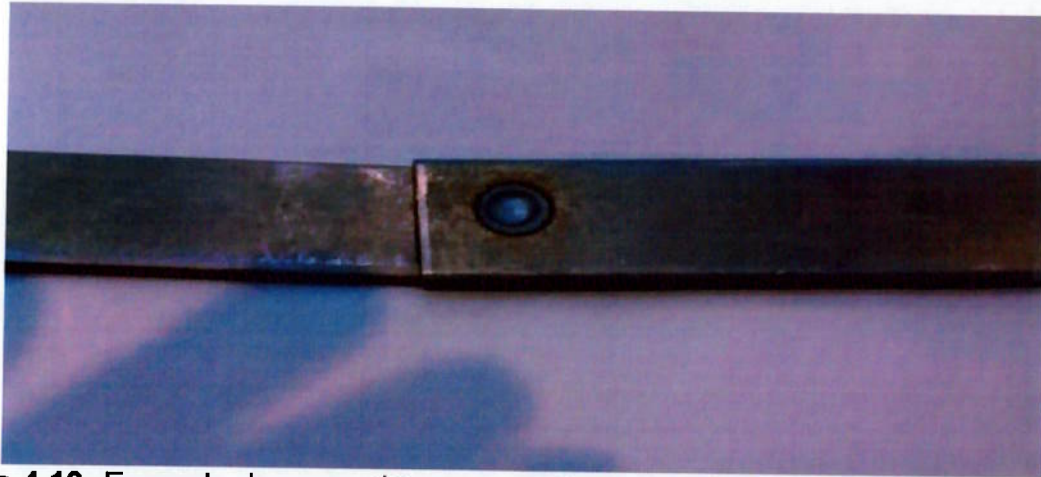
Figura 4.13: Exemplo de corpo de prova utilizado para os ensaios de tração.
