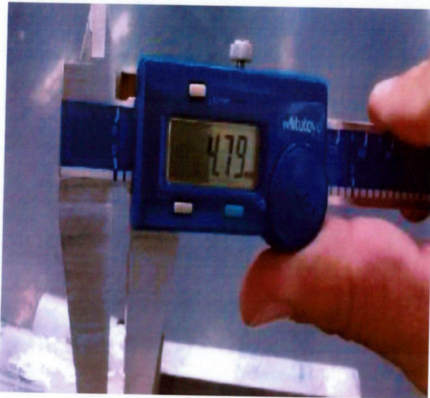
Figura 4.11: Paquímetro digital para medição dos diâmetros dos pontos de solda.
