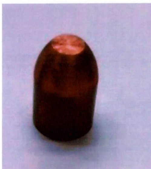
Figura 4.4: Geometria e dimensões do eletrodo face plana de contato.
