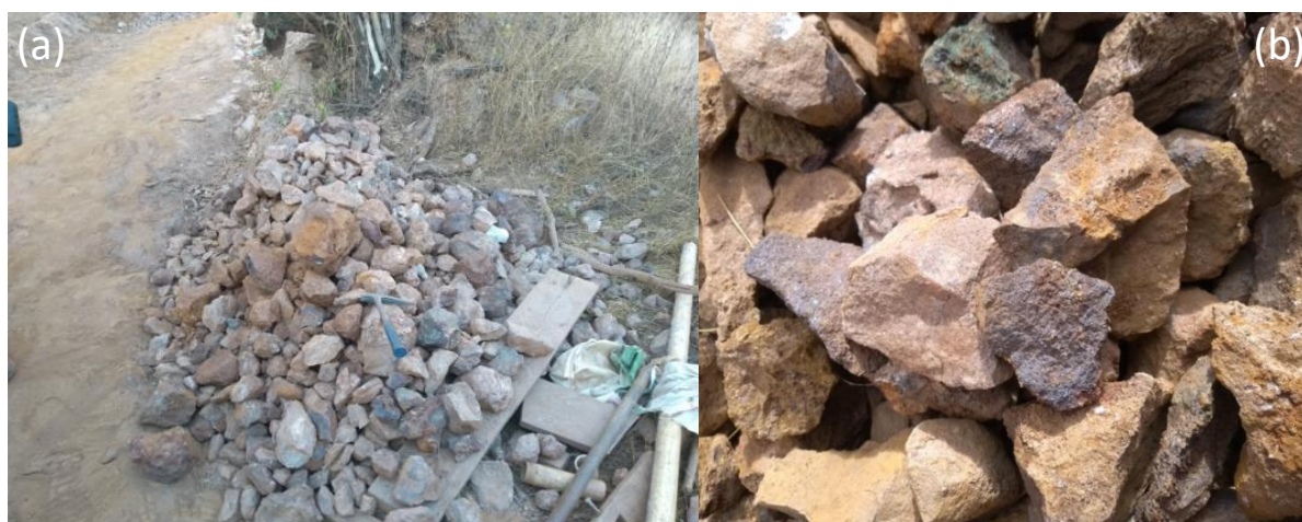
Figura 9: (a) Quartzo de veio sulfetado e oxidado mineralizado em ouro. Notar a oxidação dos sulfetos resultando óxidos hidratados de ferro e porções com tons esverdeados formados por malaquita, indicando a presença de sulfetos de cobre no minério de ouro. (b) Detalhe dos blocos, apresentando volumes significativos de hidróxidos de ferro em alguns fragmentos, evidenciando amostras mais enriquecidas em sulfetos, e um bloco com malaquita na parte superior ao centro, com cores verdes.
