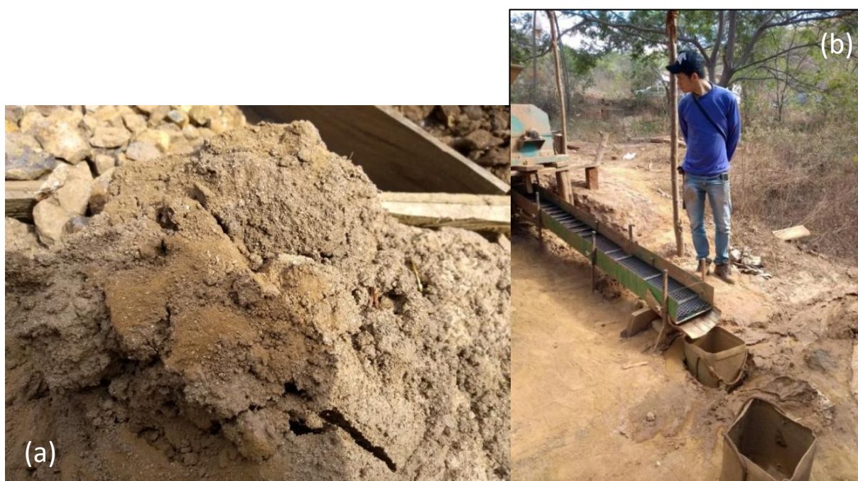
Figura 7: (a) Minério moído, pronto para concentração gravítica em calha de concentração. (b) Calha de concentração dos minerais pesados para posterior concentração por bateamento.
