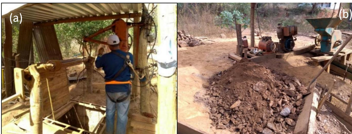
Figura 6: (a) Poço para lavra do veio mineralizado com um guincho elétrico. (b) Minério da zona oxidada (intemperizada) lavrado e depositado junto ao moinho de martelos para processamento.
