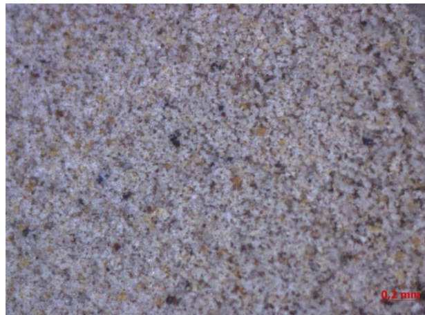
Figura 25: microscopia óptica da argila natural (NAT) com aumento de 5x
