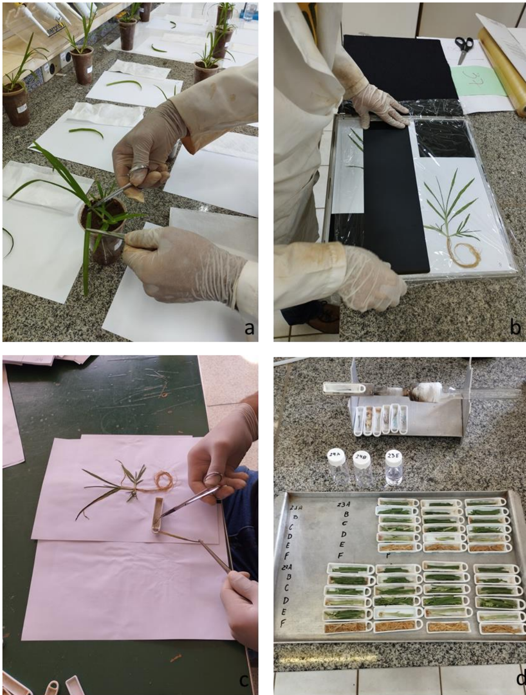
Figura 2. a) Corte da folha tratada com o produto radiomarcado. b) Plantas em exsicata sendo presadas em filme fotofosorescente. c) Seccionamento da planta em suas 5 partes. d) Amostras das partes da planta sendo queimadas em oxidador biológico.
