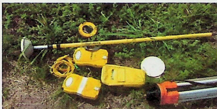
Figura 13: Equipamentos utilizados para montar a estação total. Constam antenas, base receptora e rover da marca Trimble 5700.
