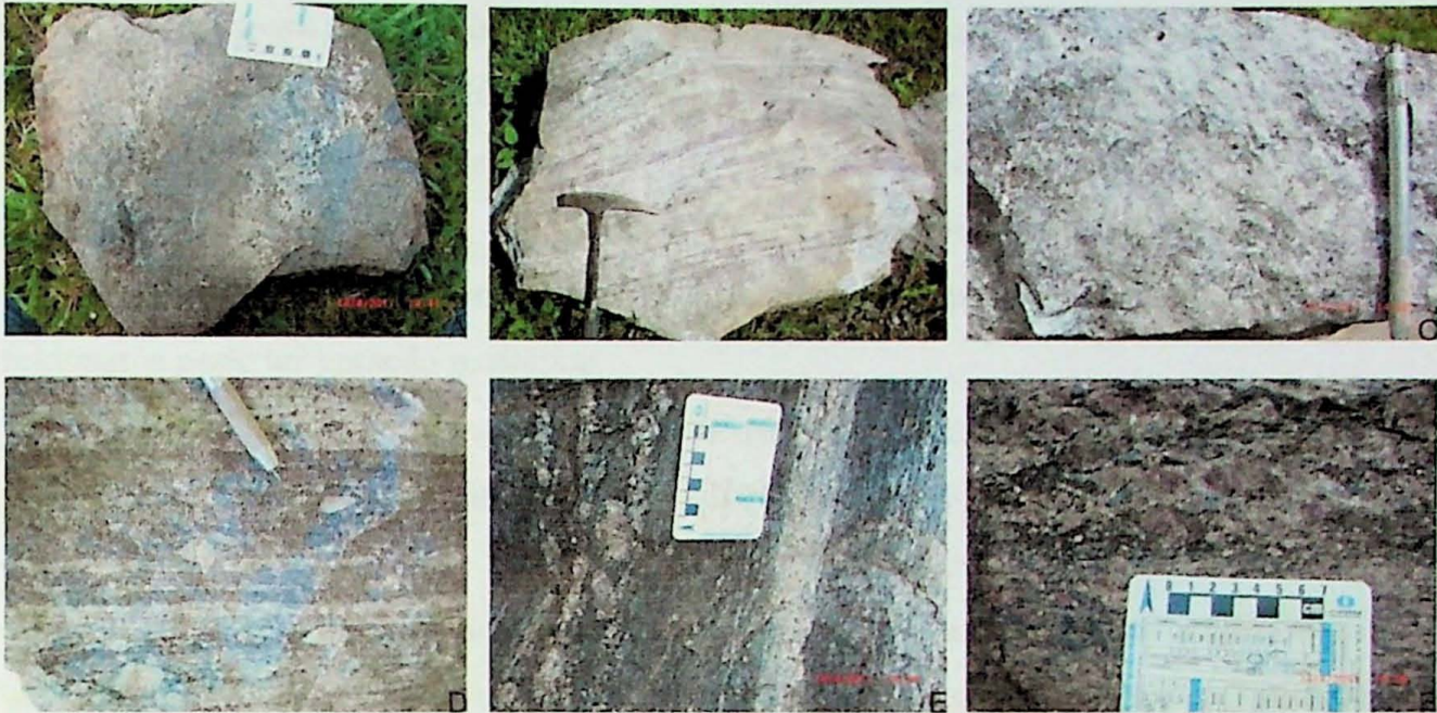
Figura 17 - IC-06: a) porção anfibolítica intercalada no resíduo; b) porção félsica com lâminas de granaditos; c) ocorrência de sillimanita em planos preferenciais; d) porfiroblastos de plagiogioclásio tipo phi; e) alternância entre bandas de leucossoma e resíduo com megacristais de k-feldspato e granada associada; f) resíduo com porfiroblastos de granada e k-feldspato com filmes de fusão associados.
