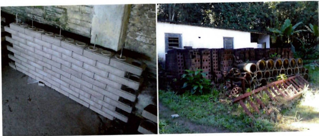
Figura 3 – Blocos e pré-moldados confeccionados com agregados reciclados na própria usina de reciclagem. Fonte: Aterro Sete Praias
