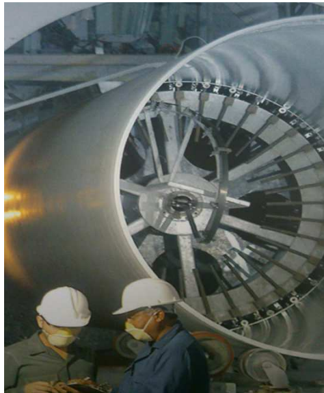
Figura 9 – Máquina de fabricação de tubo PRFV – Equipamento mandril de avanço contínuo. Fonte: Empresa estudada (2013).
