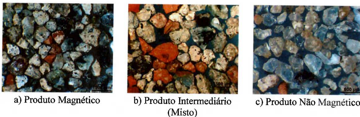
Figura 14 - Foto dos produtos Magnético e Não Magnético em RE-roll, 115 rpm, alimentação de 2,51 g/(pol.s) - Fração -1,2 +0,15 mm
