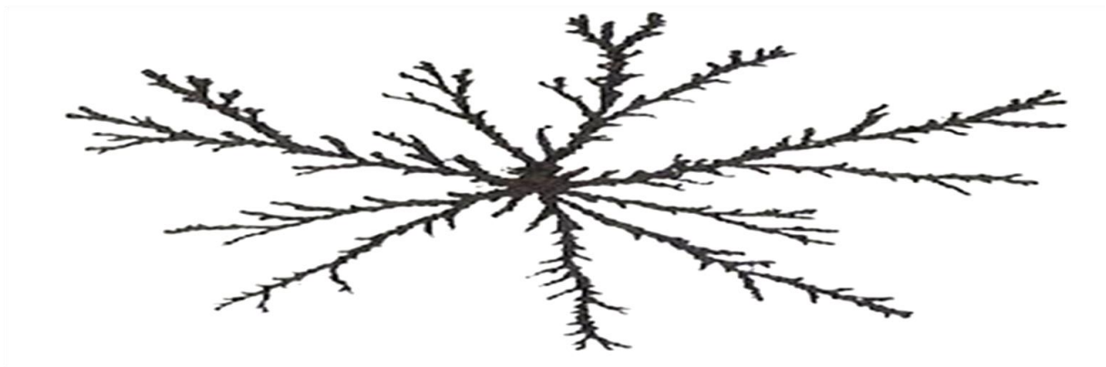
Figura 9 - Injeção de água em alta pressão num fluido viscoso. Esta estrutura fractal apresenta auto similaridade em todas as escalas. Fonte: NUSSENZVEIG (2003, p. 13).
