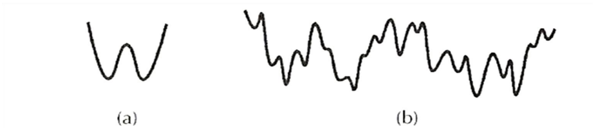
Figura 8 - Figura (a) representa um atrator único. Figura (b) representam atratores múltiplos. Nota-se como esse sistema determina histerese. Fonte: NUSSENZVEIG (2003, p. 12).
