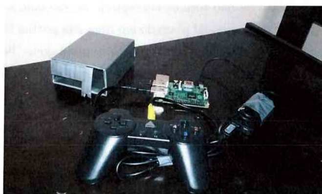
Figura 15: Montagem do console com power bank , controle, e módulo Wi-Fi
