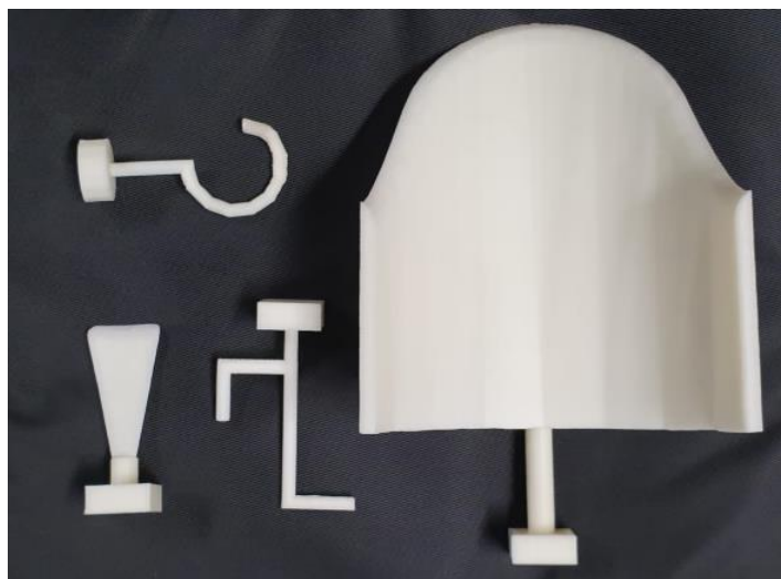
Figura 29 – Pontas intercambiáveis fabricadas em impressão 3D. Fonte: (Autor, 2020)
