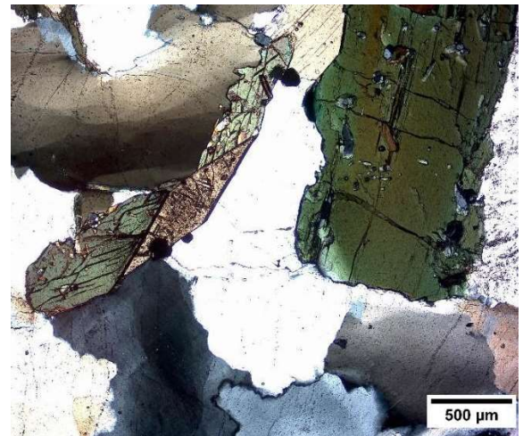
Foto 4 - Fotomicrografia da amostra PD95 – ao centro grãos euédricos de titanita; à direita anfibólio com inclusões de pequenos grãos de apatita e magnetita.
