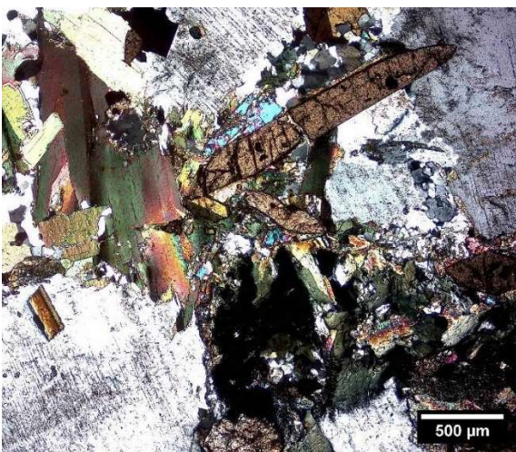
Foto 5 - Fotomicrografia da amostra PD506 – agregados de anfibólio e biotita; detalhe para os grãos euédricos alongados de grande dimensão (ao centro-superior) (nicóis cruzados).
