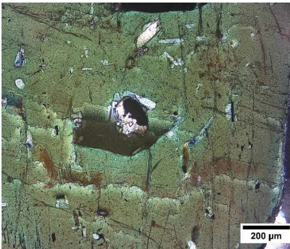
Foto 3 - Fotomicrografia da amostra PD95 – detalhe de um grão de anfibólio com diversas inclusões de apatita e zircão.
