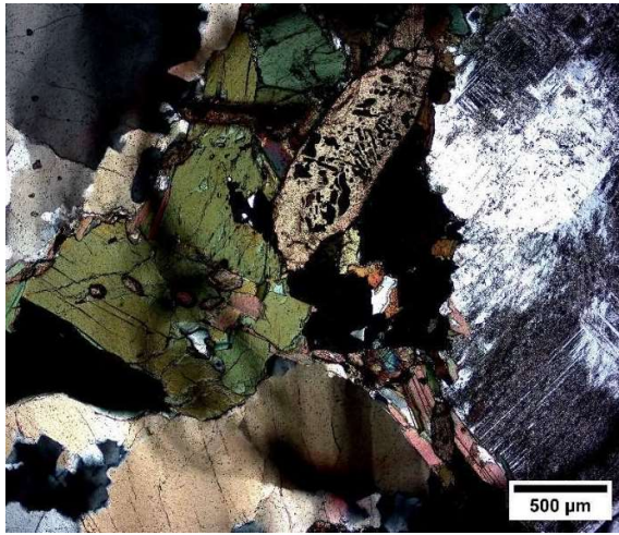
Foto 1 – Fotomicrografia da amostra PD01 - ao centro titanita subédrica, com inclusões de opacos, associada ao anfibólio e biotita (nicóis cruzados).
