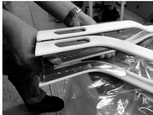
► Chegada da peça metálica. Foi necessário um pequeno desbaste para conseguir encaixar a peça perfeitamente no quadro.
