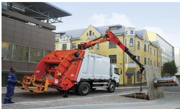
Figura 2.16: Caminhão Munck em operação
