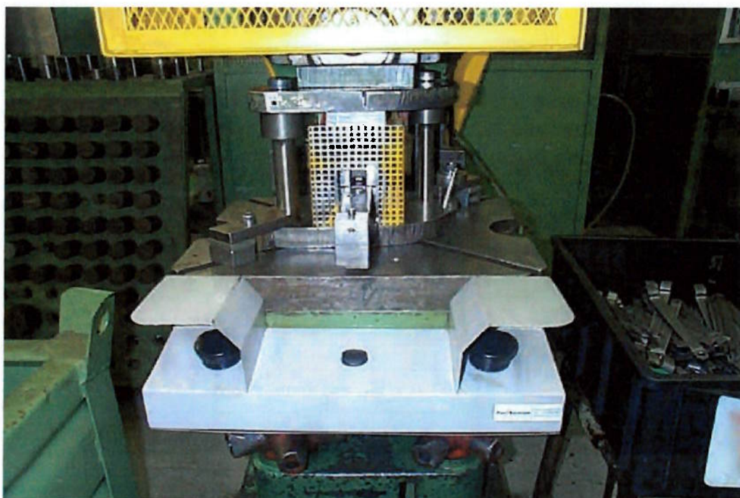
Imagem 2 – Comando Bimanual tipo IIIC conforme NBR 14152
