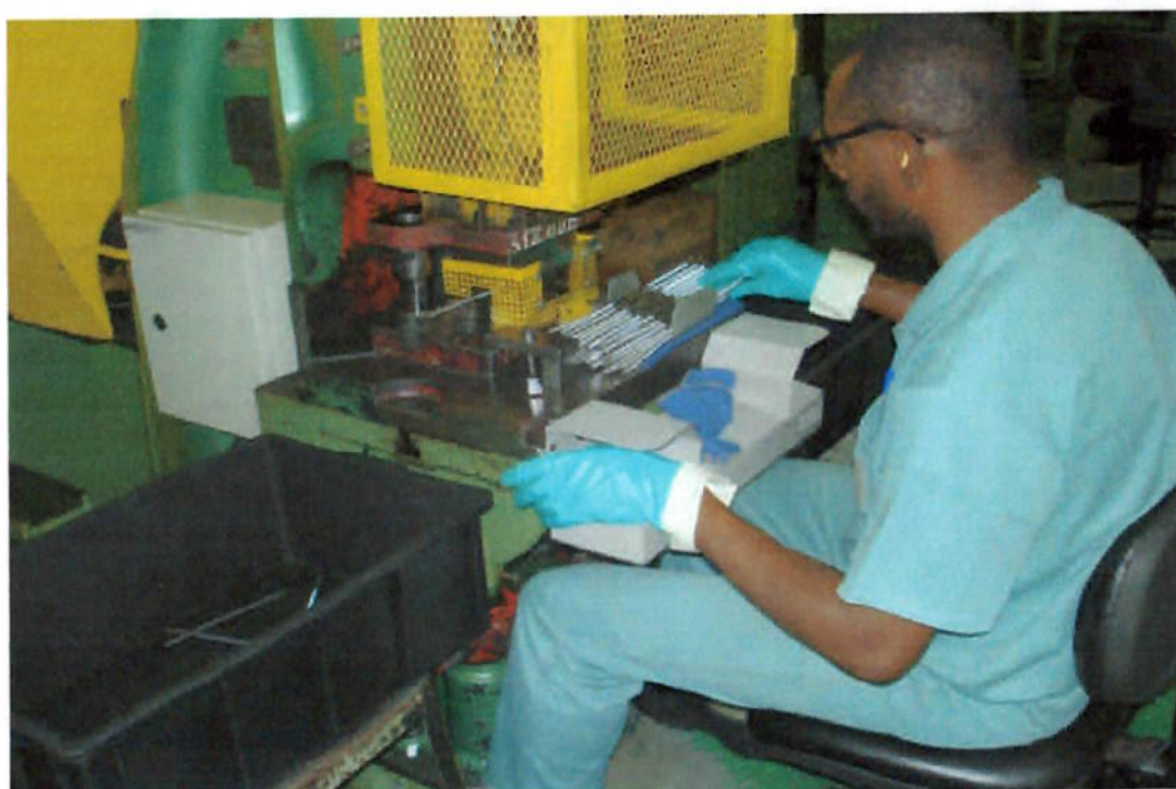
Imagem 9 - Prensa adaptada em operação
