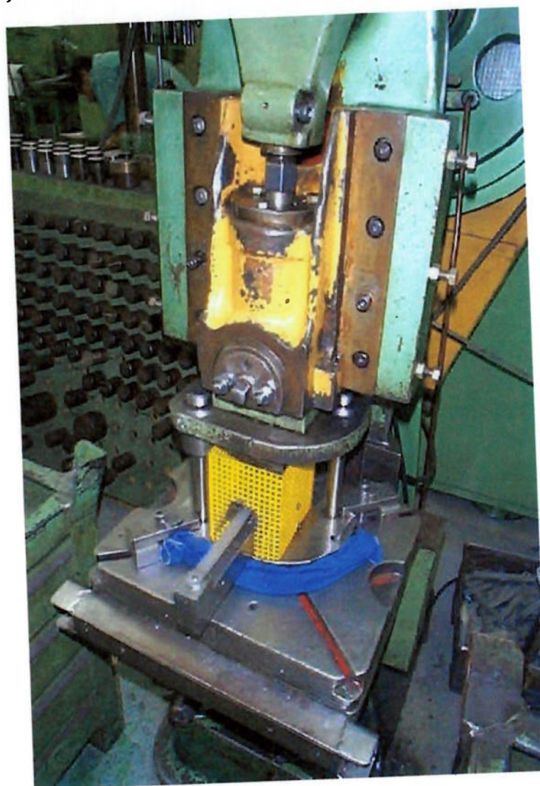
Imagem 5 – Dispositivo com enclausuramento definitivo
