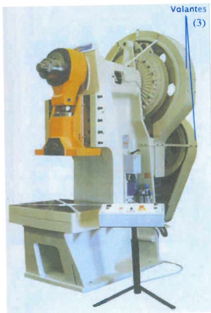
Ilustração 6 – Enclausuramento dos volantes
