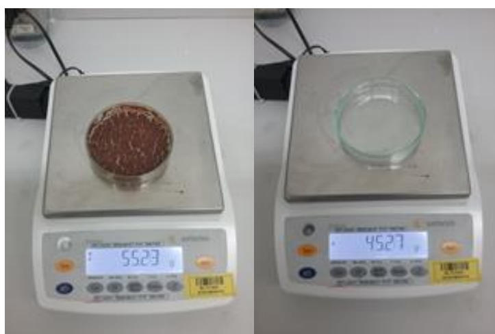
Figura 6.3: Placa com bagaço de malte desidratado e peso da placa de Petri
