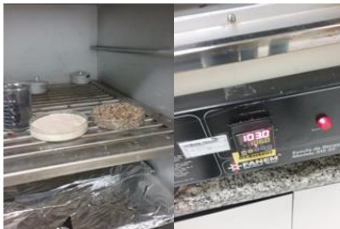
Figura 6.2: Placa de Petri no interior da estufa a 103°C
