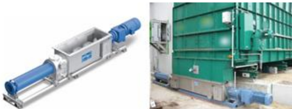
Figura 5.5: Sistema de alimentação de substrato líquido com bomba parafuso.
