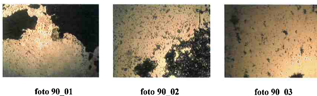
Figura 12: Microscopia óptica da blenda de PADB/PHS 90/10 em diferentes magnitudes.
