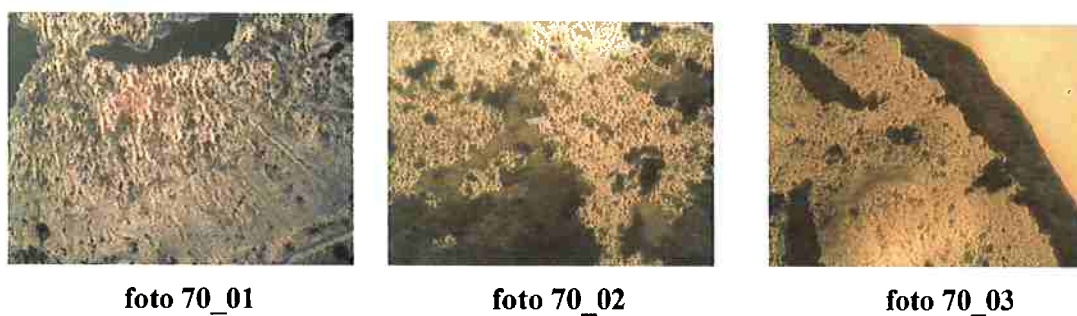
Figura 13: Microscopia óptica da blenda de PADB/PHS 70/30 em diferentes magnitudes.
