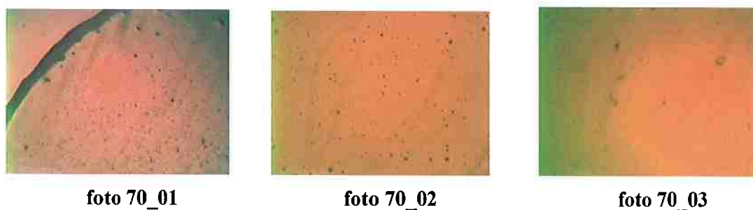
Figura 16: Microscopia óptica da blenda de PADB/PHS 70/30 em diferentes magnitudes.
