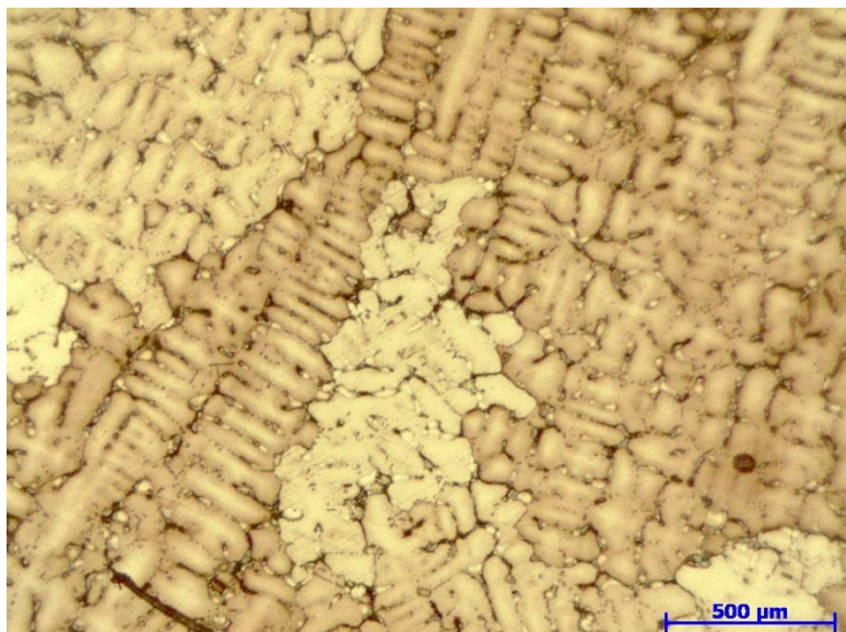
Figura 13 - Micrografia da superliga de níquel bruto de fusão com escala de 500 \mu m.
