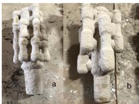
Figura 7- Molde cerâmico (a) Corpo de prova pequeno (b) Corpo de prova ASTM A781
