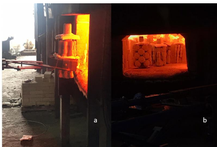
Figura 8 - (a) Molde sendo colocado no forno (b) Moldes sendo pré-aquecidos no forno a 1070°C
