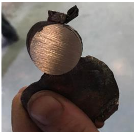
Figura 12 - Superfície lixada para análise química da superliga de níquel
