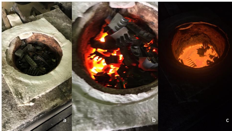
Figura 9 - Processo de fusão da superliga de níquel (a) Recém colocado no forno (b) Início da fusão do material (c) Material praticamente fundido por completo
