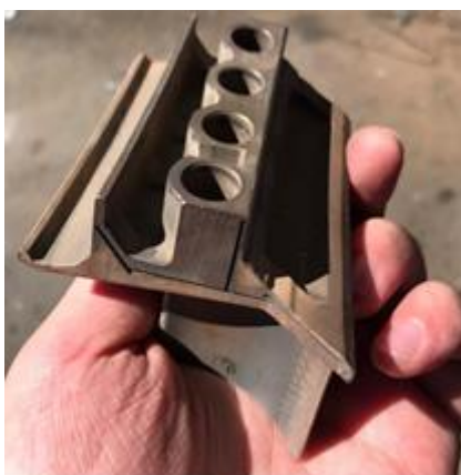
Figura 6 – Peça individual de sucata da superliga de níquel
