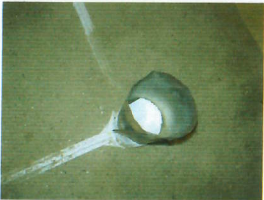
Figura 19 - canal de entrada do alumínio
