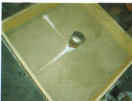
Figura 17 - modelo de isopor na caixa
