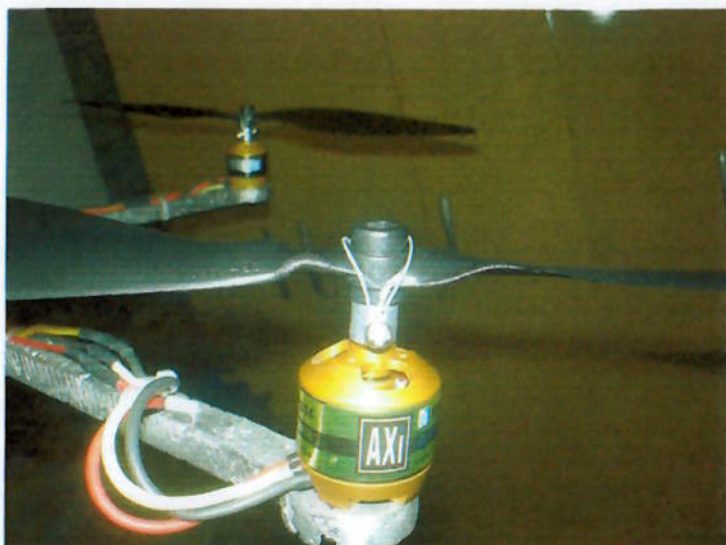
Figura 37 - inversão das pás da hélice (motores A e C)
