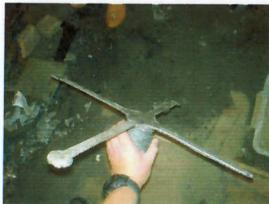
Figura 22 - modelo bruto (não rebarbado)
