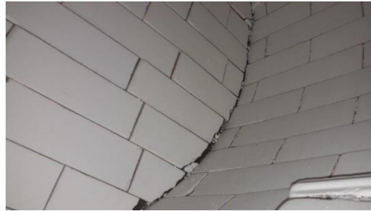
Figura 38 – Revestimento cerâmico de um moinho de bolas.
