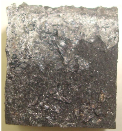
Figura 12 – Aspecto da superfície na região da fratura (Autor, 2016).
