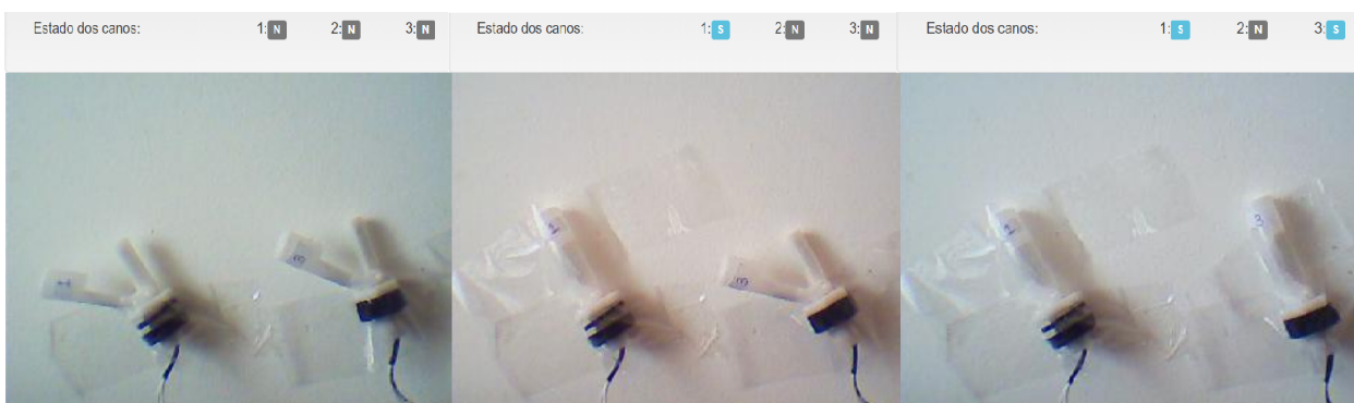
Figura 13: Teste de identificação dos sensores de nível 1 e 3.
