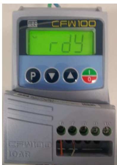
Figura 15: Inversor CFW100 junto com módulo de expansão para sinais analógicos
